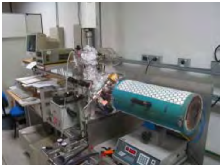
Figura 15 - Fotografia do sistema de tratamento térmico e dopagem de amostra.
