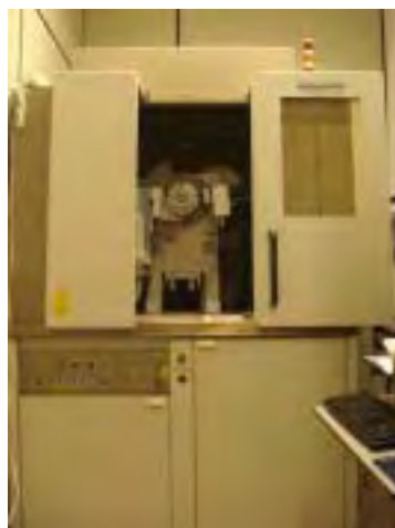
Figura 23 - Difratômetro Rigaku D/Max -2100PC, utilizado nas medidas de DRX.
