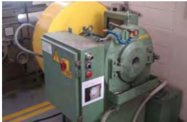
Figura 12- Equipamento de forjamento rotativo a quente, da marca FENN, modelo EF, com potência de 5 cv e velocidade de 1700 rpm.
