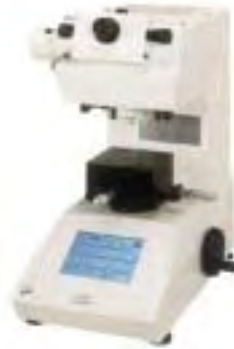
Figura 26 - Microdurômetro utilizado nas medidas de dureza.
