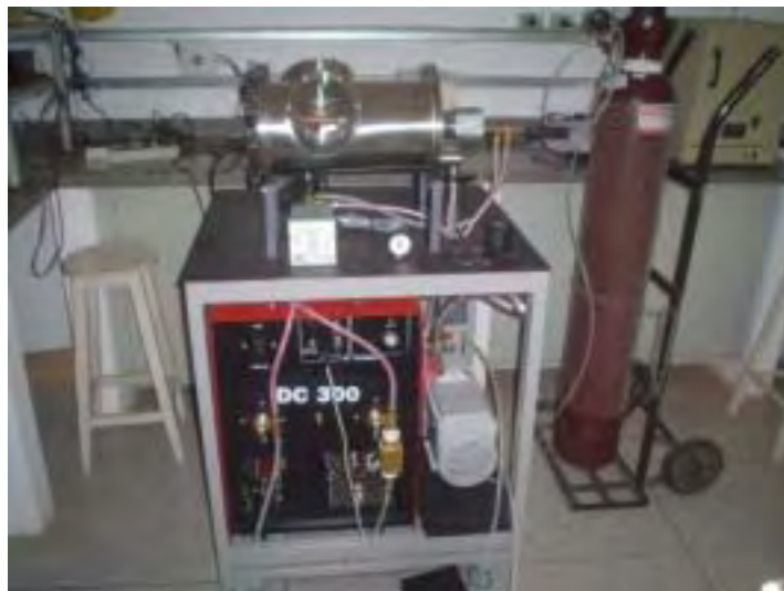
Figura 10 - Forno a arco voltaico usado na fusão das amostras.
