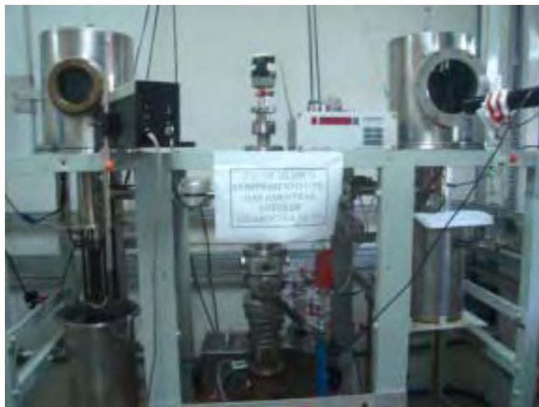
Figura 29 – Fotografia do Pêndulo de Torção utilizado nas medidas de Espectroscopia Mecânica.
