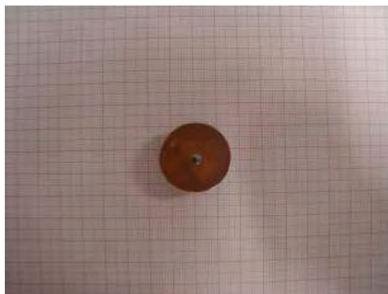
Figura 25 – Amostra embutida para o polimento.
