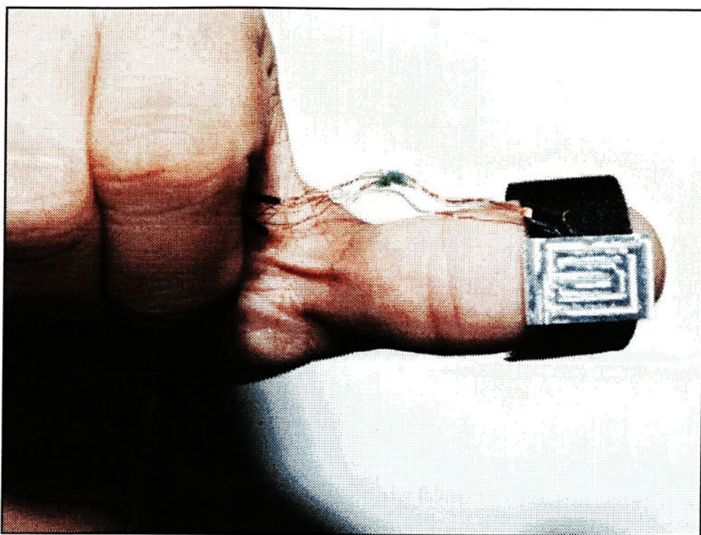
Figura 4.22B - Foto do sensor tátil individual colado ao velcro e instalado no dedo polegar.
