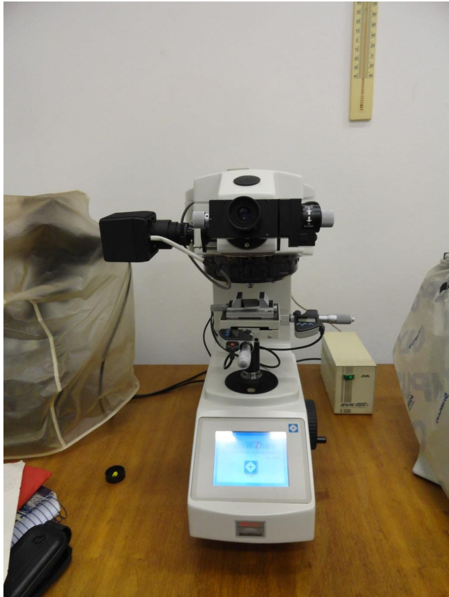
Figura 31. Micrôdurometro utilizado na aferição da microdureza.
