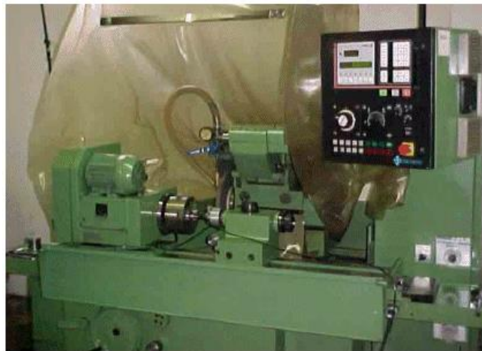
Figura 17. Fotografia da retificadora cilíndrica de mergulho disponível no LUA.
