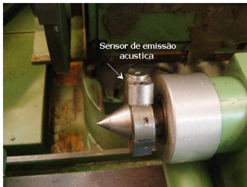
Figura 23. Posicionamento do sensor de emissão acústica.
