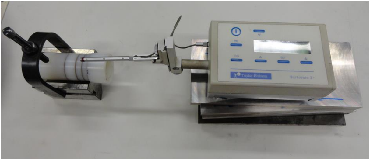
Figura 25. Rugosímetro e suporte utilizados para medir a rugosidade das peças.
