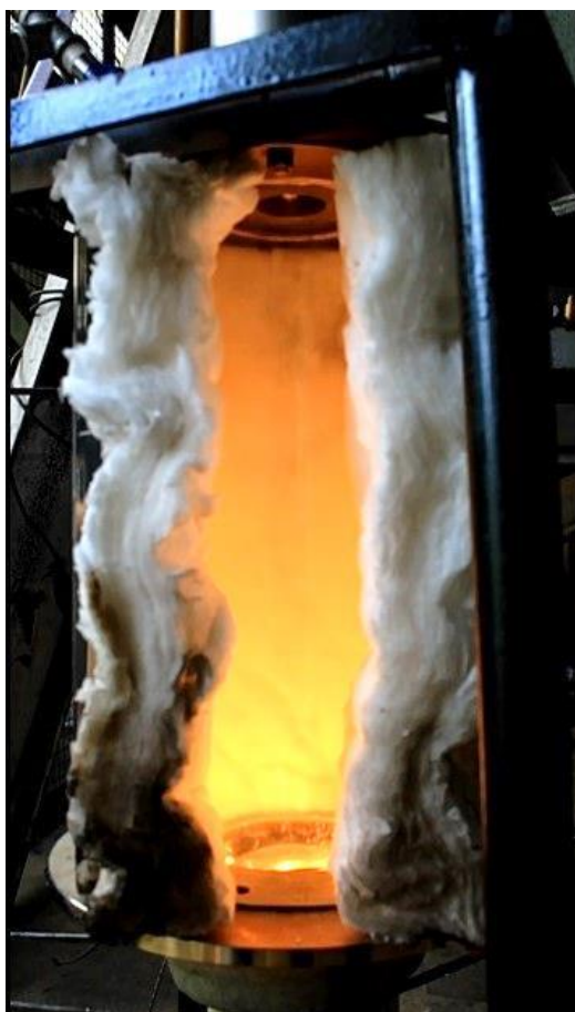
Figura 4.15 - Ausência de uma chama visível no interior da câmara em condições típicas do regime de combustão sem chama visível
