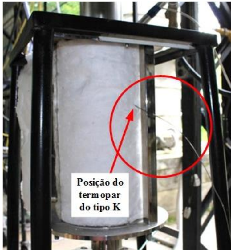
Figura A. 13 - Posição do termopar do tipo K na parede da câmara
