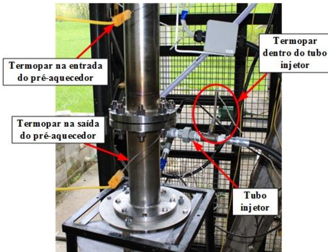
Figura 3.15 - Posição do tubo injetor de combustível líquido
