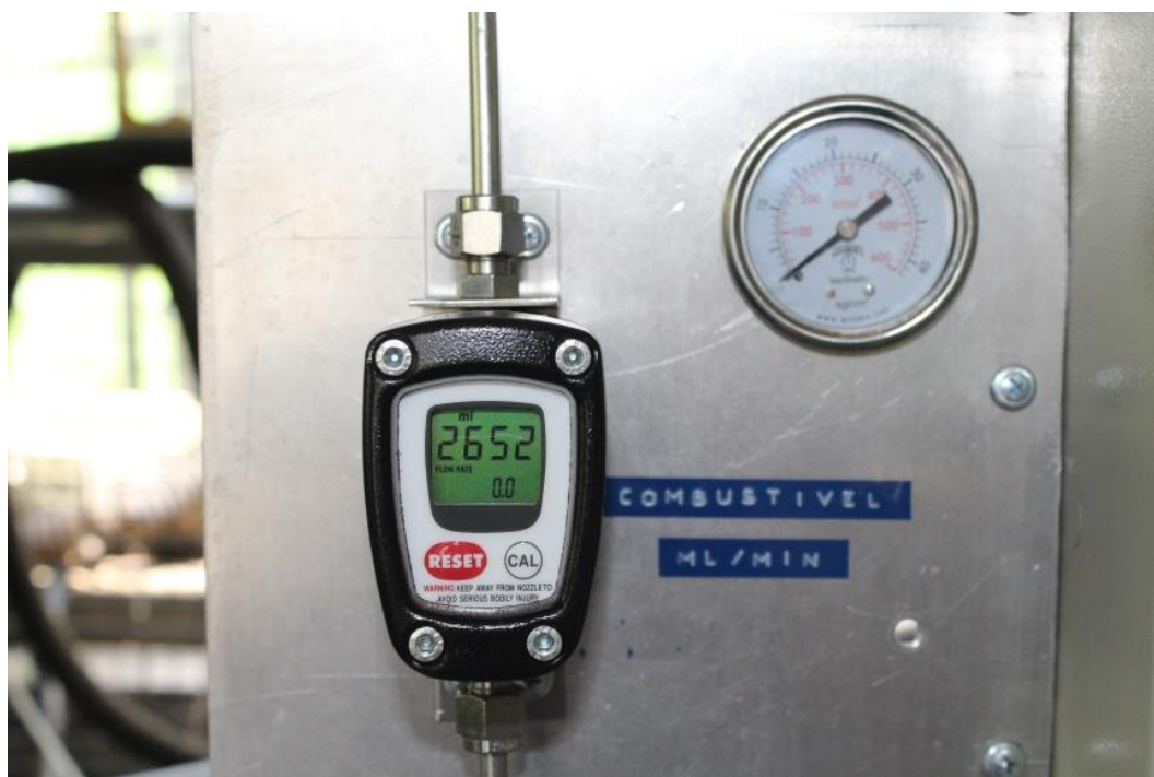
Figura A. 12 - Rotâmetro digital para medir a vazão de biodiesel no atomizador
