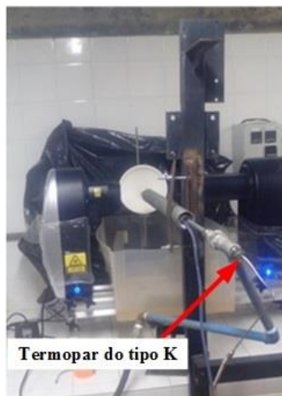
(b) Posição do termopar do tipo K
