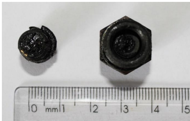
Figura 3.18 - Ocorrência da carbonização do biodiesel dentro do atomizador
