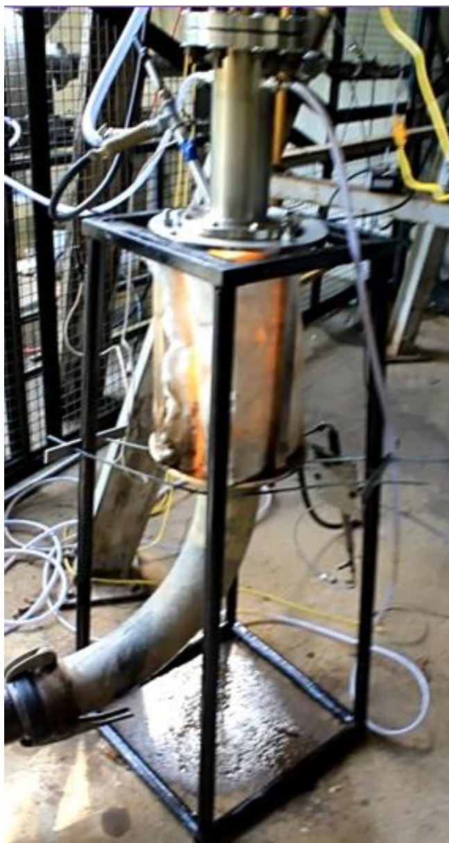
Figura A. 15 - Posição da sonda de amostragem de gases
