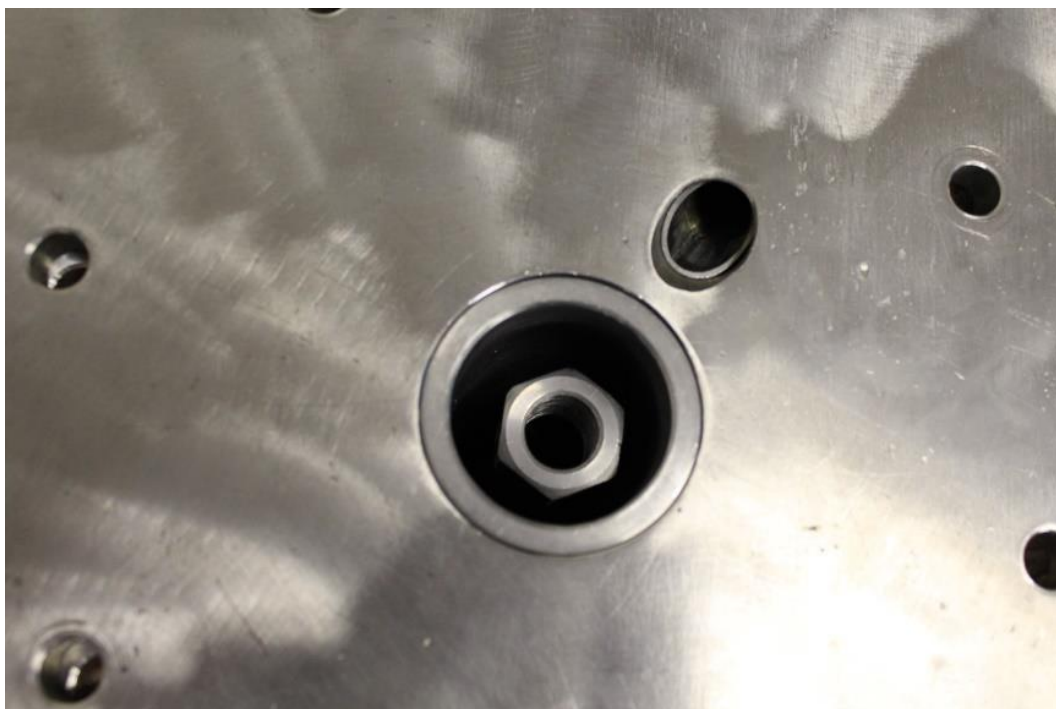
Figura A. 7 - Detalhes do queimador principal e do queimador piloto
