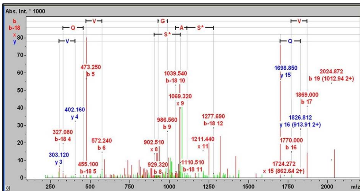
S48. Espectro CID da sequência peptídica S.SSIGQVNY*GAAS*QFAQVVGQ.S (602-621), selecionando-se o íon de m/z 1086.040 na forma de [M + 2H]^{2+} , como precursor; e mostrando os sítios de fosforilação Y609 e S613 observados na proteína espidroína-2 ( spot 4), que foi secretada pela glândula ampulada maior e identificada na 2-DE da seda.
