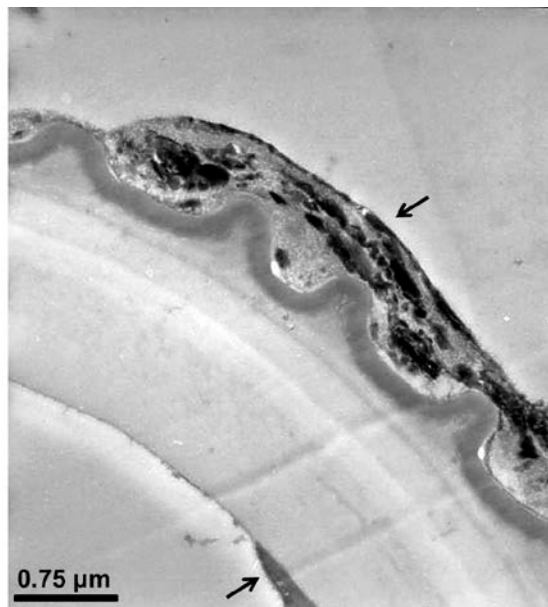
Figura 56. Microscopia eletrônica de transmissão (MET) com técnica de citoquímica para detecção de lipídeos. Fibras da seda mostrando a deposição de material lipídico formando uma camada lipídica sobre a fibra (setas).
