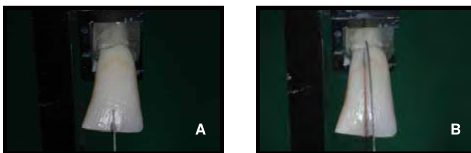
Figura 8 – Preparo das amostras: a e b) secção da coroa do dente bovino no sentido incisivo-cervical com disco diamantado em Labcut.
