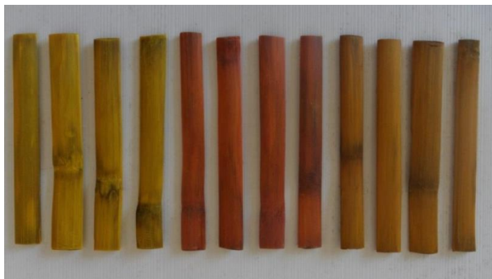
Figura 46. Ripas de Gynerium sagittatum depois de serem sometidas ao processo de tingimento e fixação das cores.
