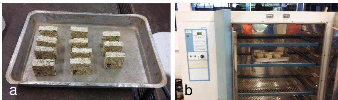
Figura 26. – a), b), corpos de prova para ensaio de teor de umidade.
