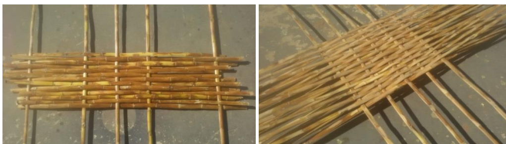
Figura 44. Resultado trançado tipo cesto com ripas sem regularização dimensional das bordas.
