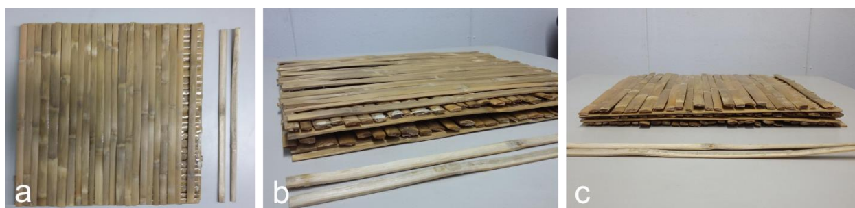
Figura 53. Painel de Gynerium sagittatum e resina de óleo de mamona depois do processo de prensagem manual a frio.
