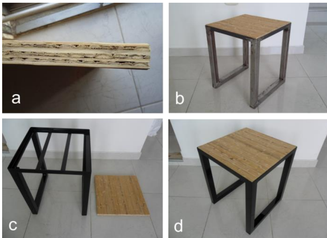
Figura 70. Processo de design de produto mobiliário conceitual MB. — a) bordas do painel, b) modelo sem acabamento, c) componentes, d) modelo terminado.
