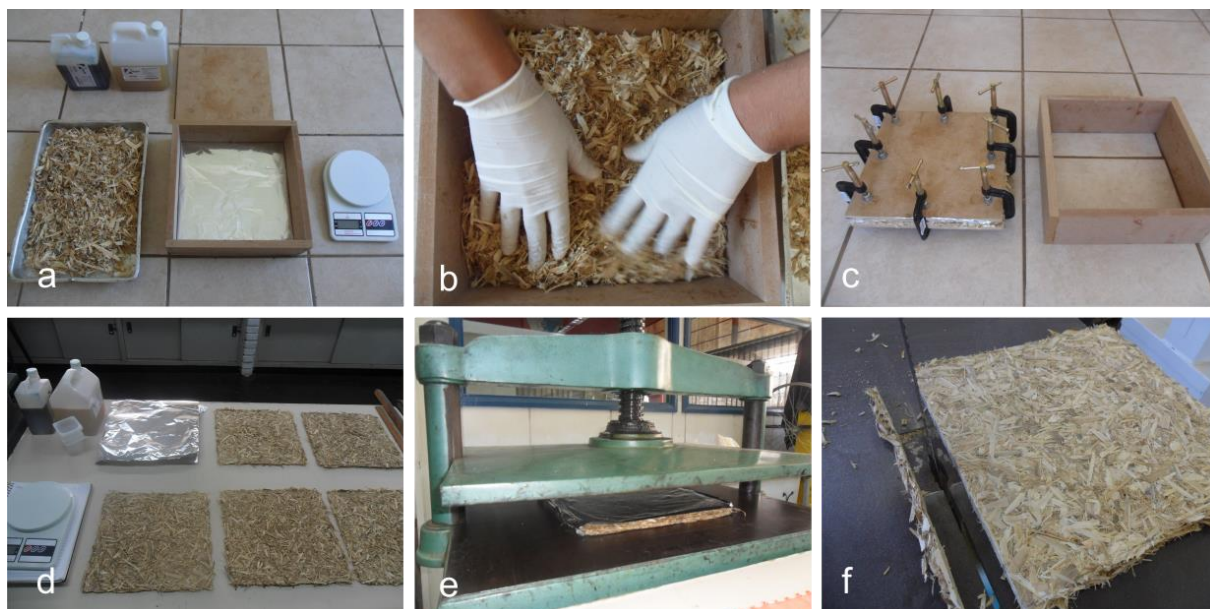
Figura 19. Métodos de produção painel aglomerado com 5 camadas de partículas de Gynerium sagittatum . - a) preparação, b) mistura partículas e resina, c) prensagem camada, d) preparação placa, e) prensagem camadas, f) acabamento painel.
