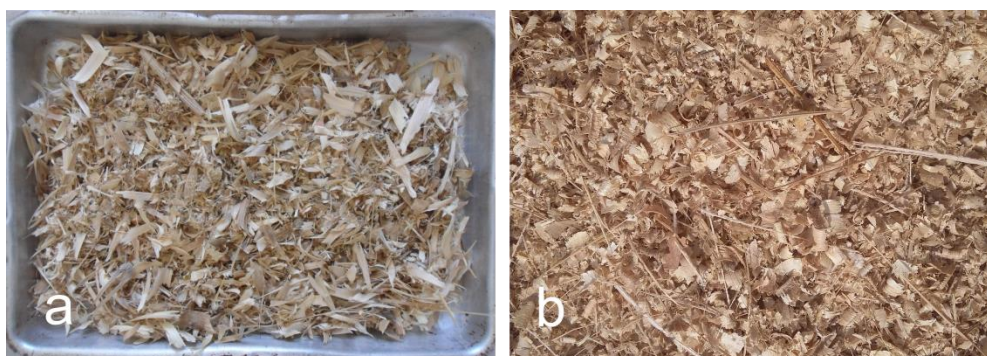
Figura 40. - a) partículas, produto do beneficiamento manual, b) partículas produzidas usando plaina.
