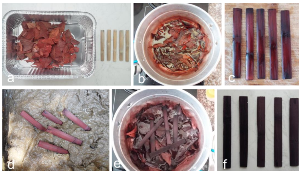
Figura 15. Tingimento vegetal em ripas de Gynerium sagittatum com Arrabidaea chica , grupo 1 preparado inicialmente com lama. - a) folhas e ripas com mordente, b) tingimento por cocção, c) ripas tingidas, d) inserção em mordente, e) segunda cocção, f) ripas tingidas.
