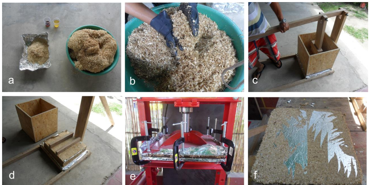
Figura 20. Métodos de produção painel aglomerado de partículas de Gynerium sagittatum prensado em prensa hidráulica á frio. - a) preparação, b) mistura partículas e resina, c) pré-prensagem, d) Colchão pré- prensado, e) prensagem á frio prensa hidráulica, f) painel de partículas.
