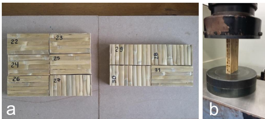
Figura 36. – a), b), corpos de prova no ensaio de compressão longitudinal.
