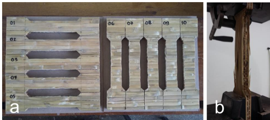
Figura 36. – a), b), corpos de prova no ensaio de compressão longitudinal.
