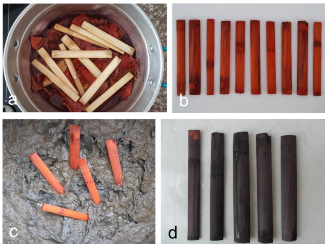
Figura 16. Tingimento vegetal em ripas de Gynerium sagittatum com Arrabidaea chica , grupo 2 e grupo 3. - a) tingimento por cocção, b) ripas tingidas sem mordente, c) inserção em mordente, d) ripas tingidas com mordente.
