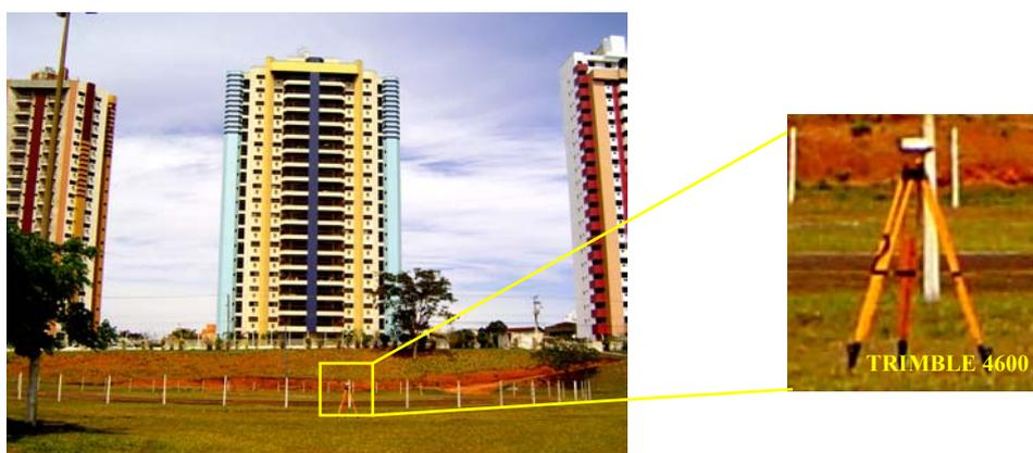
FIGURA 30 - Receptor Trimble 4600 LS no local do primeiro experimento
