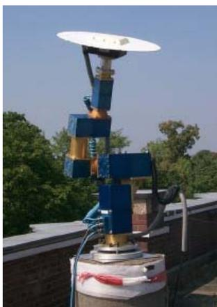
FIGURA 12 - Robô para calibração do centro de fase
