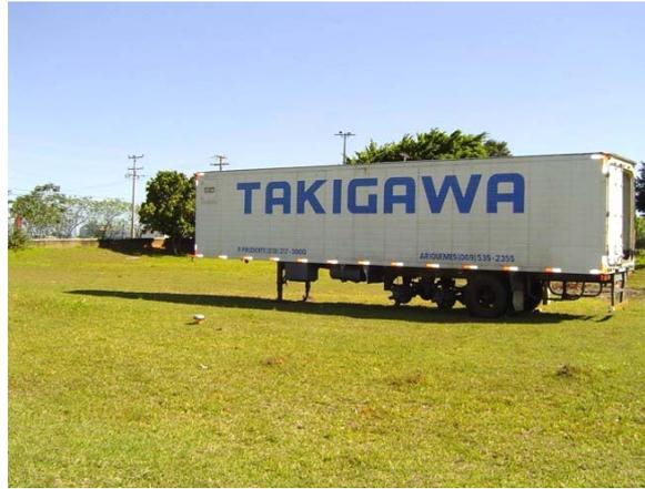
FIGURA 34 - Objeto refletor (carreta) colocado a 6 m do receptor Trimble
