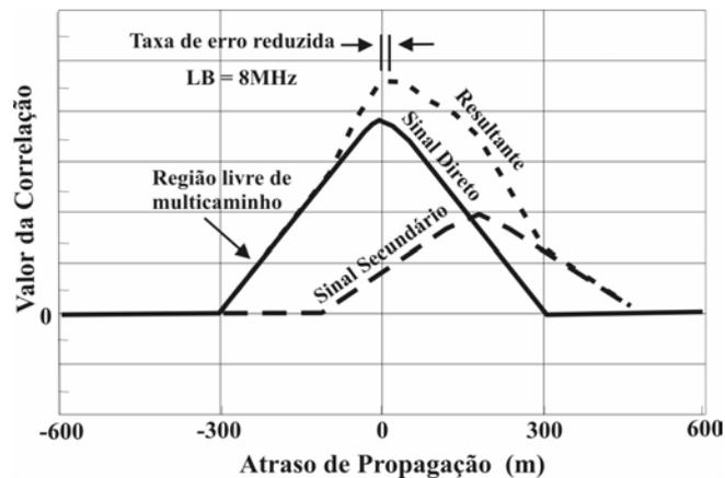
FIGURA 15 - Taxa de erro reduzida causada pelo multicaminho (LB = 8MHz)
