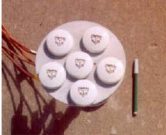
FIGURA 10 - Antenas proximamente espaçadas
