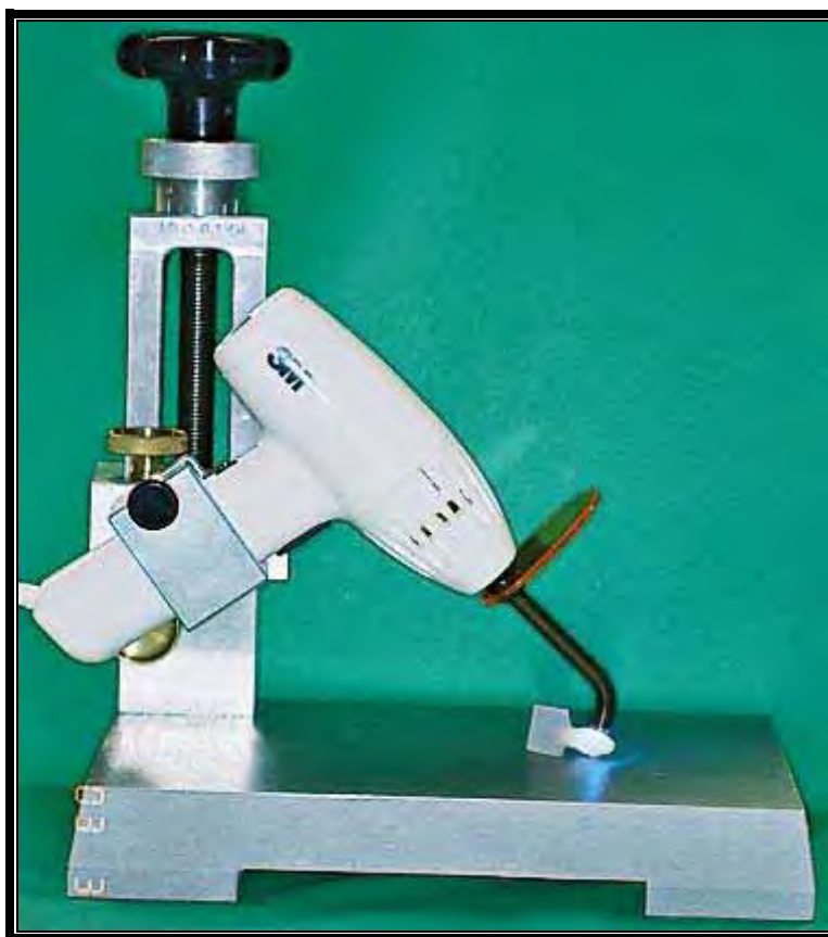
FIGURA 4 – Dispositivo usado para regular a distância da fonte de luz com o Aparelho fotopolimerizador XL3000 – 3M.
