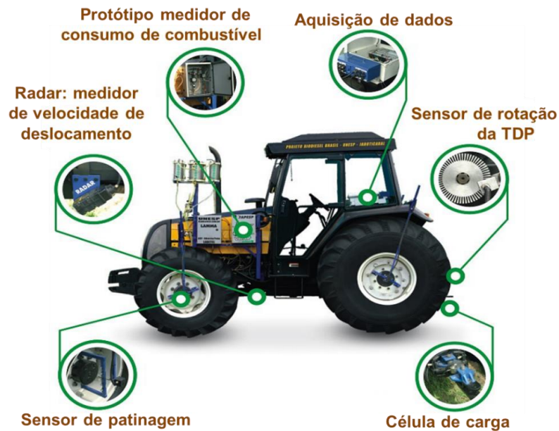
Figura 2. Trator de teste com instrumentação completa. Adaptado de Lopes (2006).
