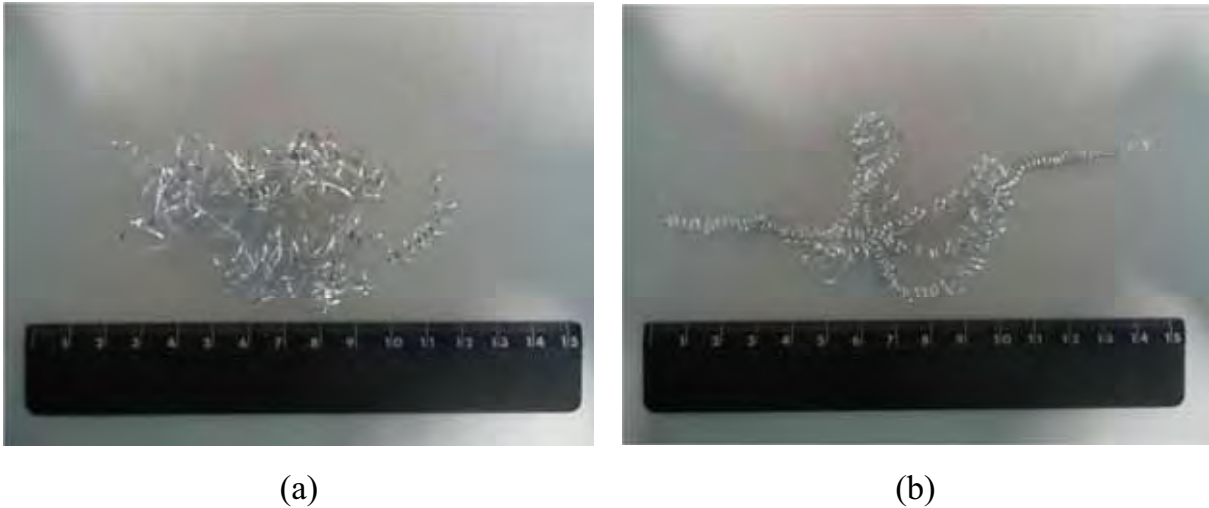
Figura 27 – Documentação do cavaco obtido após o primeiro (a) e último (b) passe na usinagem do CDP 01 com refrigeração abundante, v_c = 500 m/min e f = 0,1 mm/rev.
