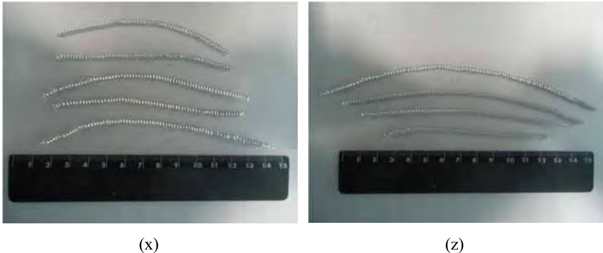
Figura 53 – Documentação do cavaco obtido após o primeiro (x) e último (z) passe na usinagem do CDP 06 com refrigeração MQF, v_c = 300 m/min e f = 0,3 mm/rev.
