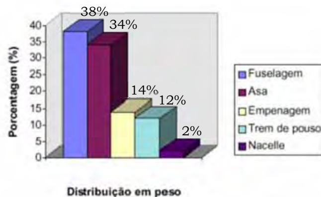
Figura 2 – Distribuição em peso dos componentes estruturais em um Boeing 767 (GODEFROID E BASTIAN, 1993).
