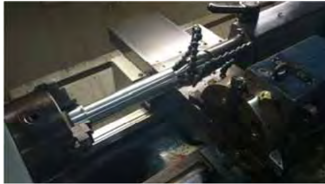
Figura 17 – Bicos direcionadores do sistema MQF.
