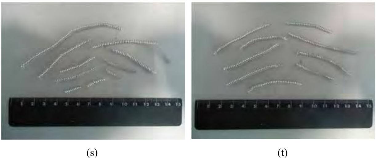
Figura 48 – Documentação do cavaco obtido após o primeiro (s) e último (t) passe na usinagem do CDP 04 com refrigeração MQF, v_c = 500 m/min e f = 0,3 mm/rev.
