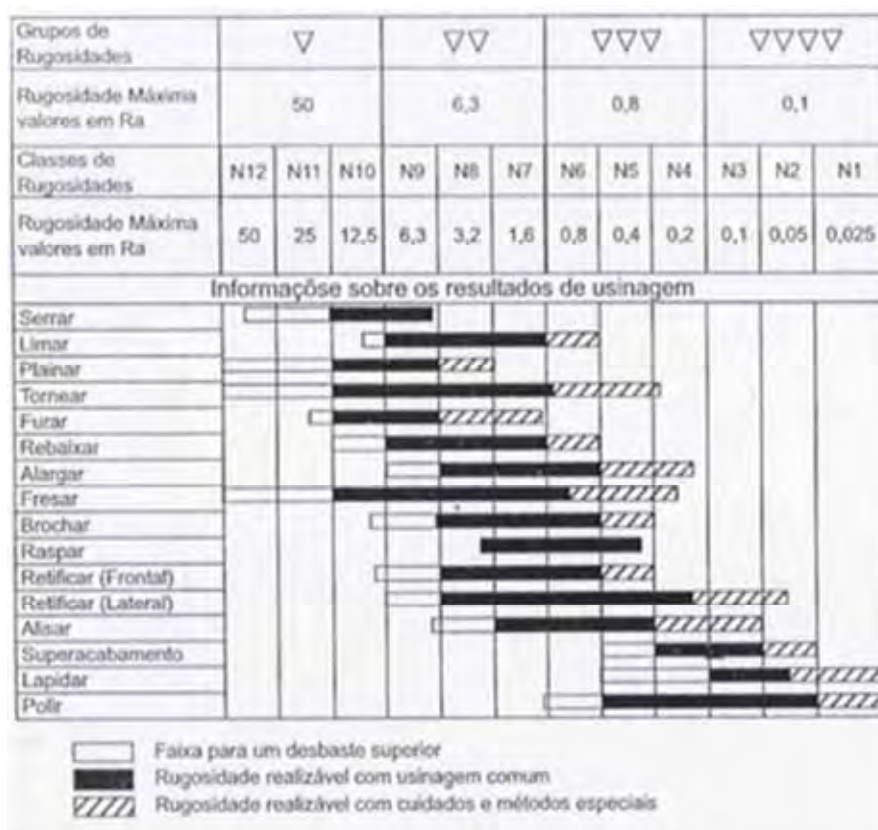
Figura 9 – Variação da rugosidade em função do processo de usinagem utilizado, adaptado de Camargo (2002).
