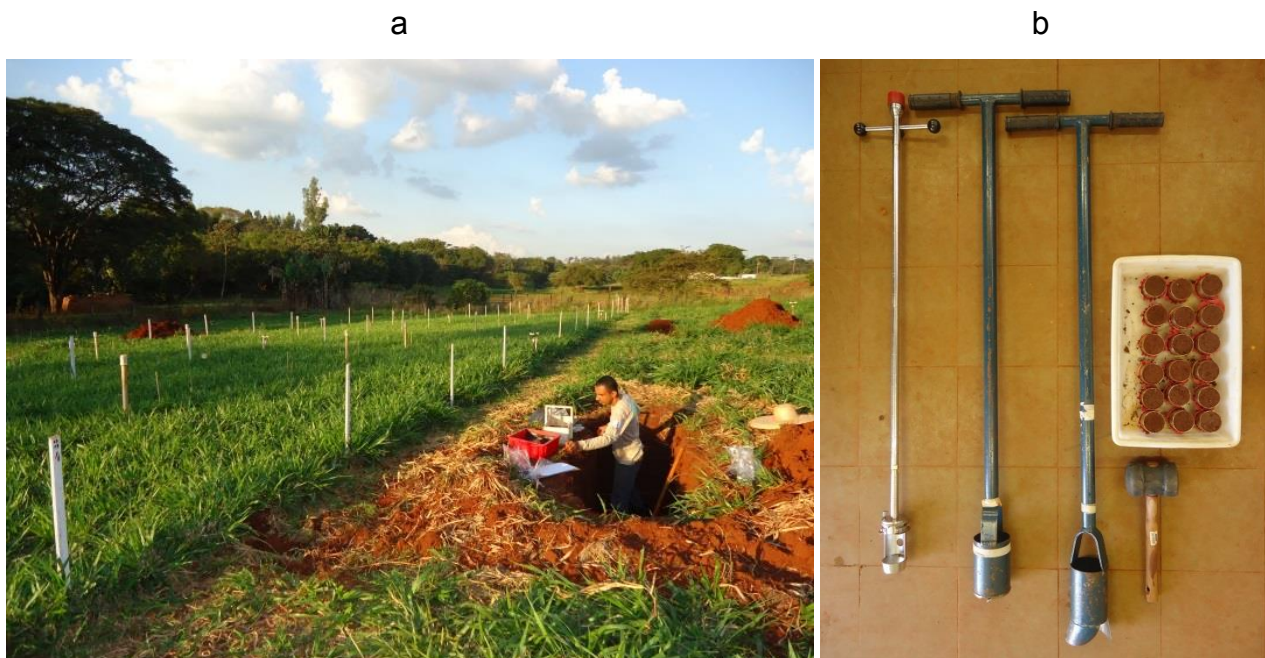
Figura 10. Coleta de amostras deformadas e indeformadas para caracterização física do solo através da abertura de trincheira (a) e com trado de caneca (b).
