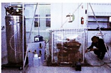
Figura 7: Desinfestação por atmosferas modificadas.
