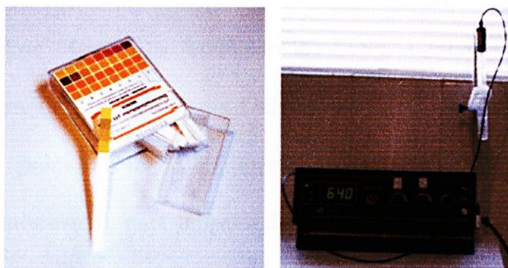
Figura 43: Fita para medir pH de superfícies (à esquerda) e peagâmetro para medir pH de soluções (à direita).
