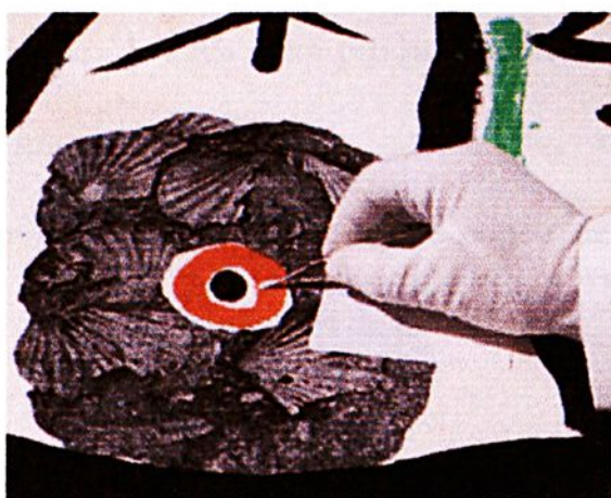
Figura 41: Teste de solubilidade de pigmentos.
