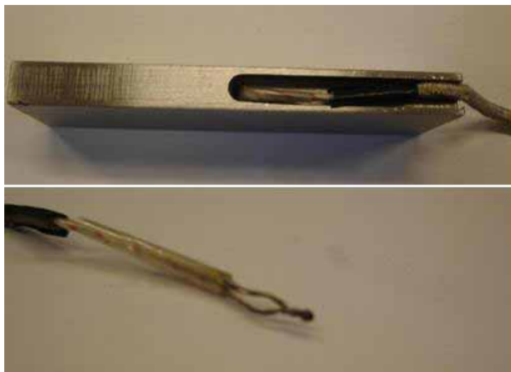
Figura 3.4: Fixação do termopar na peça de trabalho
