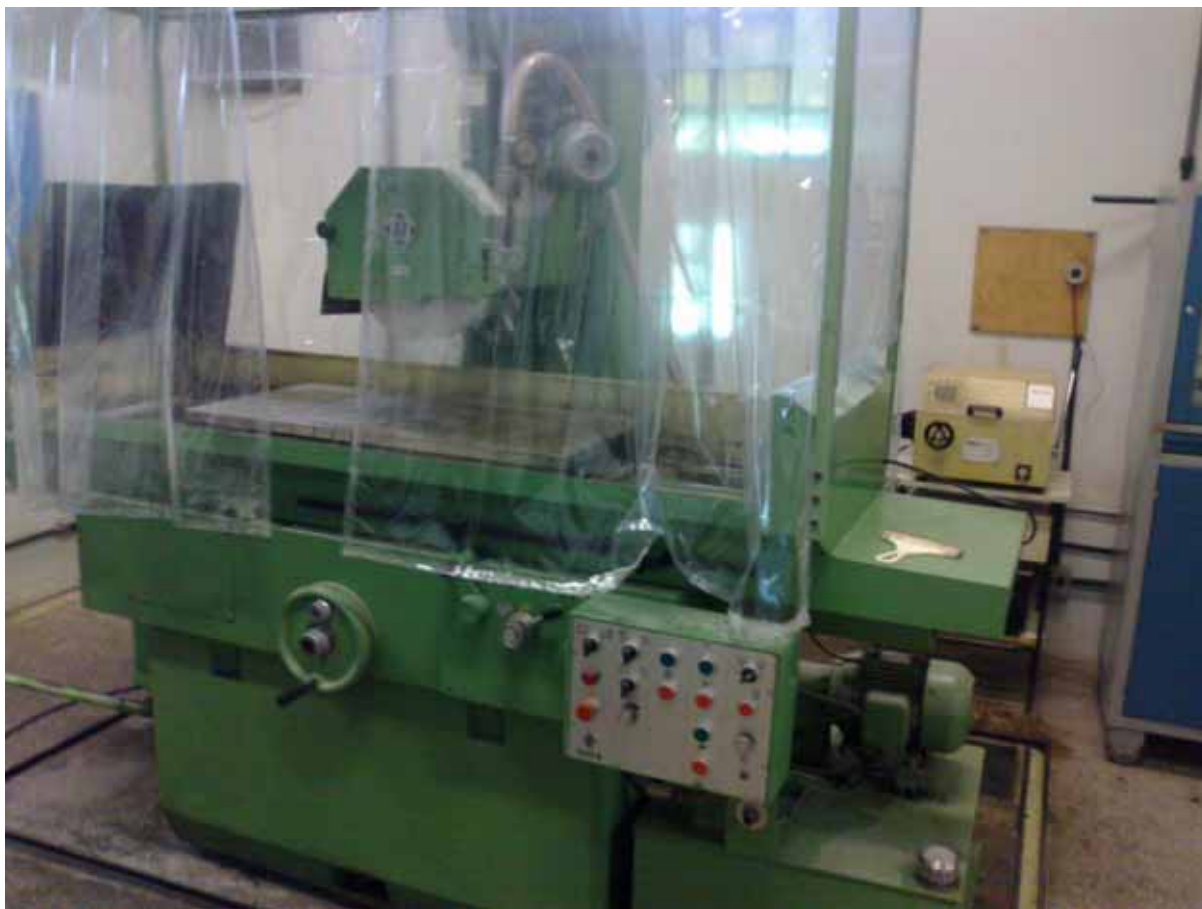
Figura 3.1: Máquina retificadora plana universal utilizada nos ensaios.
