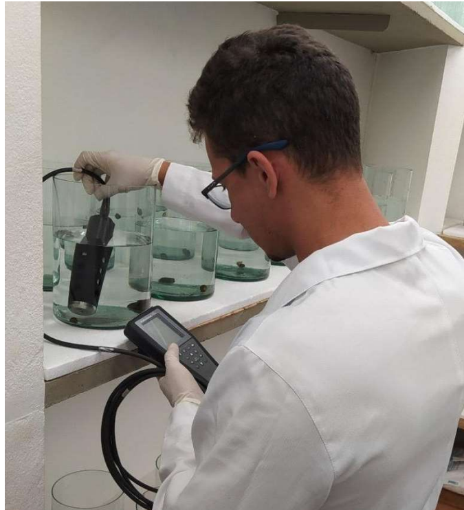
Figura 3 – Monitoramento das variáveis de qualidade de água com sonda multiparâmetro YSI® nos ensaios com bifentrina.
