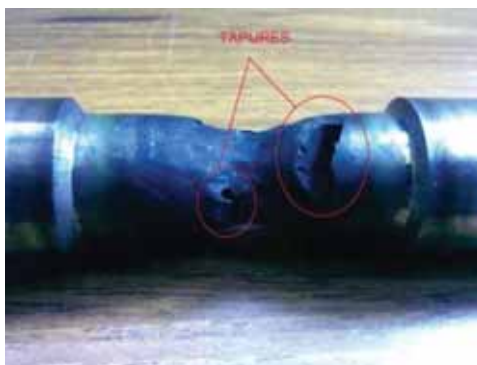
Figura 21 – Corpo de prova após o ensaio de tração a quente
