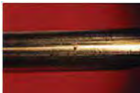
Figura 4 – Corrosão por pites ou puntiforme (WEBSITE: dutosquimica.blogspot.com, 2010)
