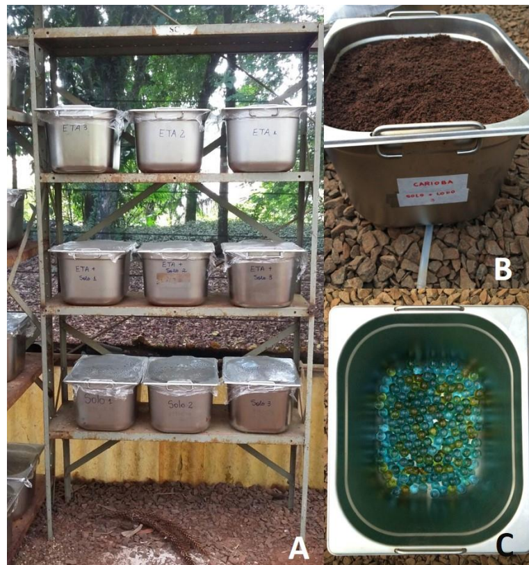
Figura 1. A. Cubas de inox acondicionadas no jardim experimental da UNESP – Campus de Rio Claro; B. Cuba de inox contendo a amostra; C. Cuba de inox contendo as esferas de vidro que ficaram por baixo das amostras.
