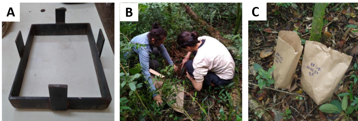
Figura 4. Coleta de amostras de serapilheira e solo: a) Moldura de ferro (30 cm x 30 cm x 5m) b) Processo de raspagem do solo c) amostras coletadas.
