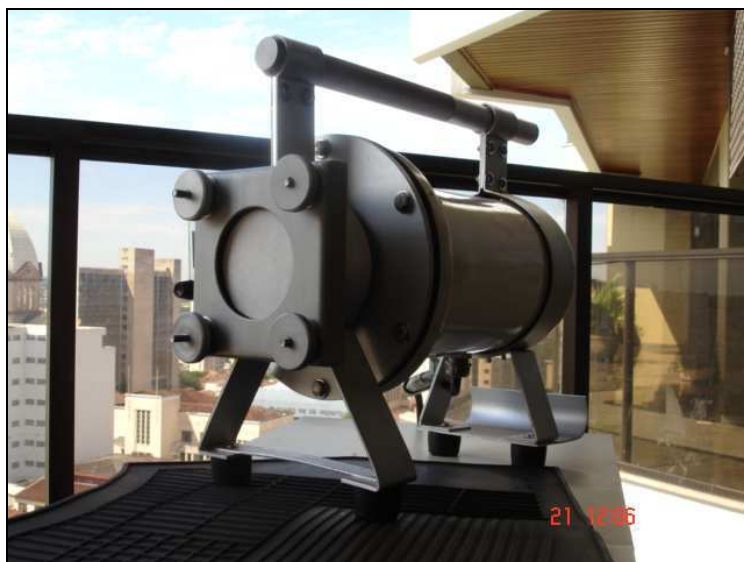
Figura 7. Aparelho portátil HANDI-VOL que foi instalado na sacada do edifício localizado no centro da cidade.
