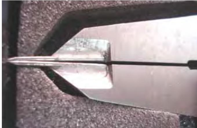
Figura 8 - Paquímetro Modificado
