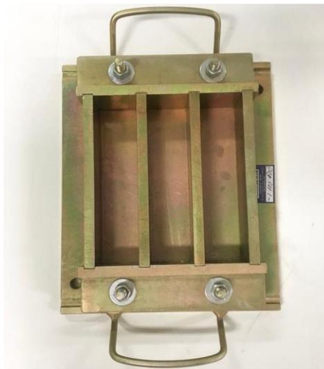
**Figura 5 (a):** Forma prismática tripla de  $40 \times 40 \times 160 \text{ mm}^3$ .
