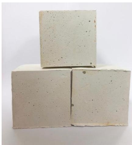
**Figura 4 (b):** Corpos de prova cubico utilizado para ensaio.
