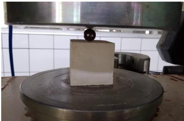
*Figura 11: Realização do ensaio de dureza superficial.*
