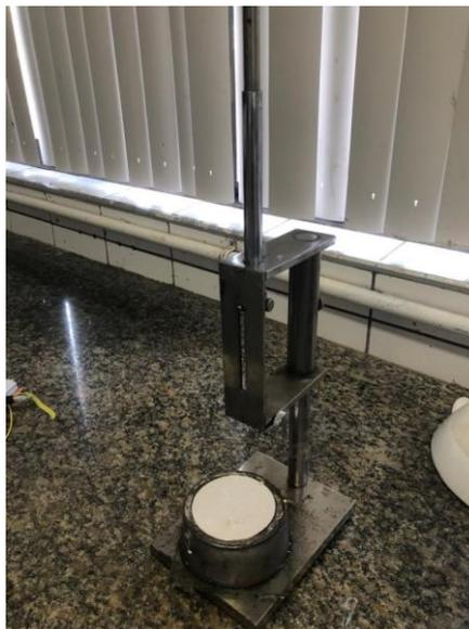
*Figura 7: Aparelho Vicat na realização do ensaio de tempo de pega.*
