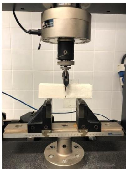
*Figura 9: Realização do ensaio de flexão.*
