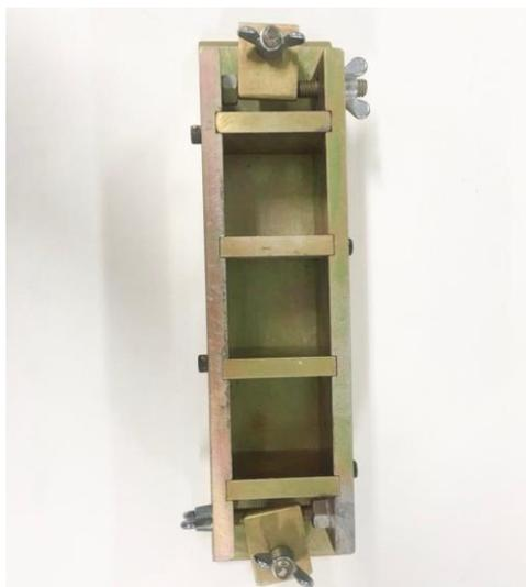
**Figura 4 (a):** Forma cubica tripla de 50x50x50mm<sup>3</sup>.
