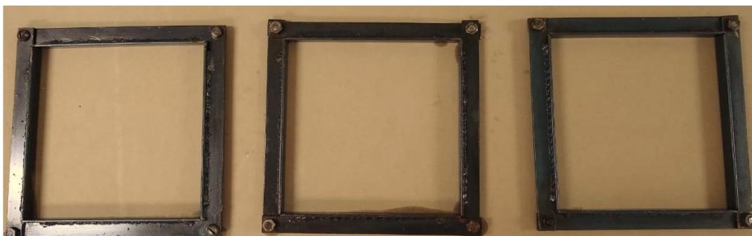
**Figura 6 (a):** Forma quadrada de  $190 \times 190 \times 20 \text{ mm}^3$ .
