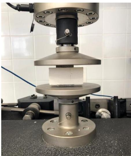
*Figura 10: Realização do ensaio de compressão axial.*
