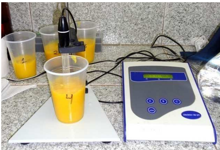
Figura 14. Medição do pH com uso de pHmetro.
