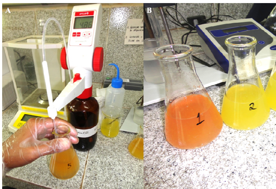
Figura 12. Titulação com NaOH (A) e ponto de viragem (B) para avaliação da AT.
