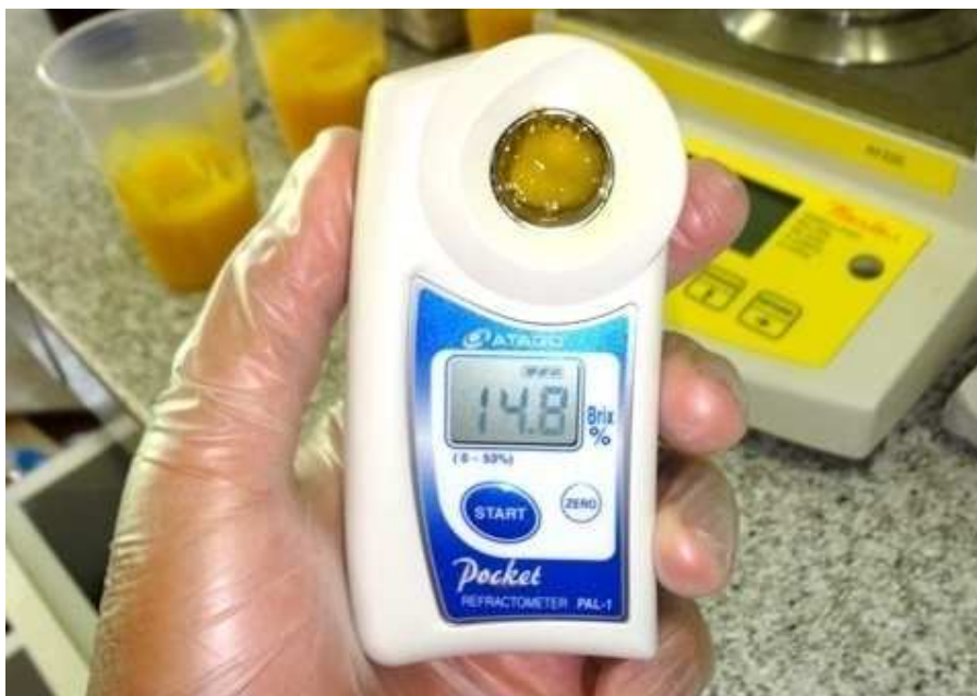
Figura 13. Medição do teor de sólidos solúveis com auxílio de refratômetro digital.
