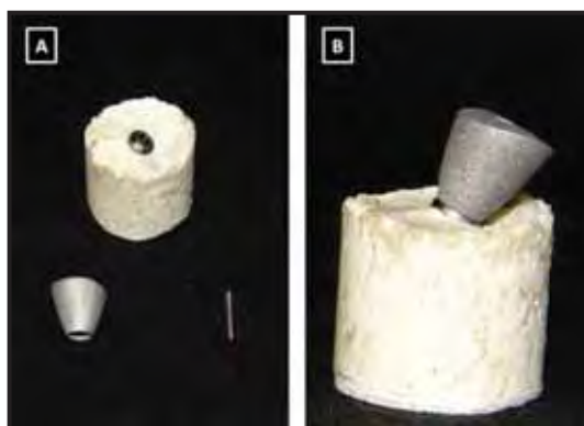
Figura C9 - A) Implante de conexão externa devidamente embutido e respectivos coroa e parafuso de retenção protético. B) Corpo-de-prova finalizado referente ao grupo CEU.
