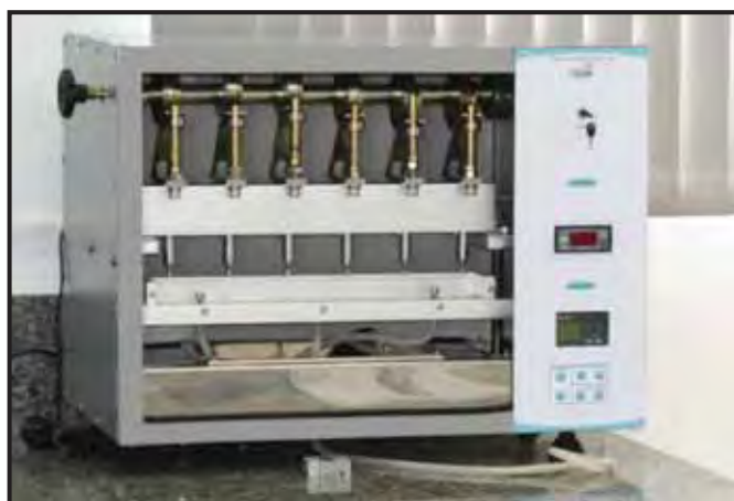
Figura C22 – Vista frontal do equipamento eletromecânico de ensaio de fadiga por mastigação, no qual os corpos-de-prova foram submetidos à ciclagem mecânica.
