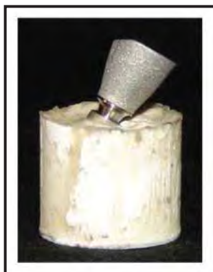
Figura C21 – Corpo-de-prova contendo o implante no interior do cilindro de resina e a coroa parafusada, prontos para aplicação do carregamento (ciclagem mecânica).
