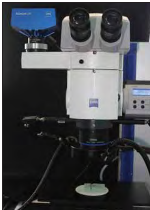
Figura C13 - Estereomicroscópio SteREO Discovery.V20 utilizado para as mensurações de desadaptação vertical das coroas protéticas parafusadas.
