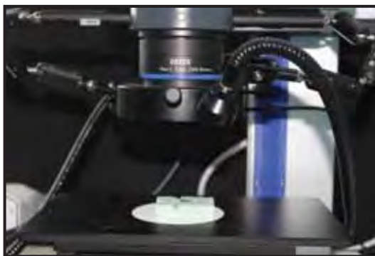
Figura C17 – Vista aproximada do espécime posicionado para mensuração da desadaptação vertical da coroa protética parafusada.
