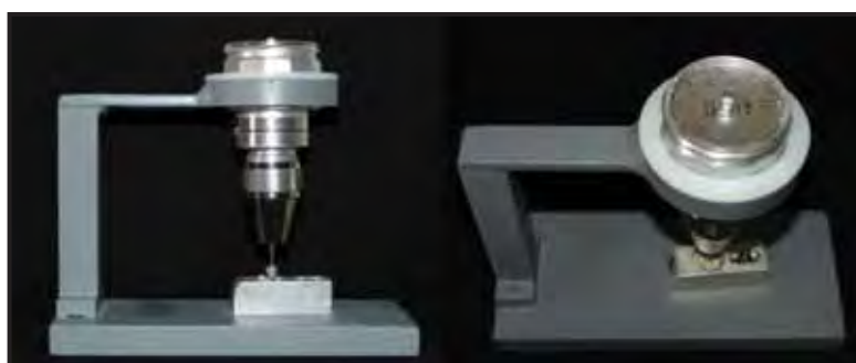
Figura C19 – Vista lateral e superior dos dispositivos metálicos responsáveis pelo posicionamento do medidor analógico de torque e do corpo-de-prova durante as mensurações.
