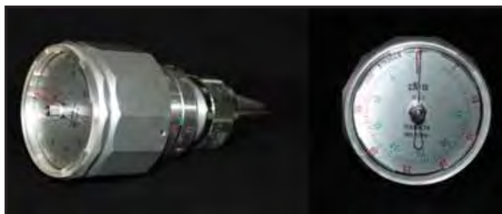
Figura C18 – Vista lateral e superior do medidor analógico de torque (Tonichi BTG36CN-S).
