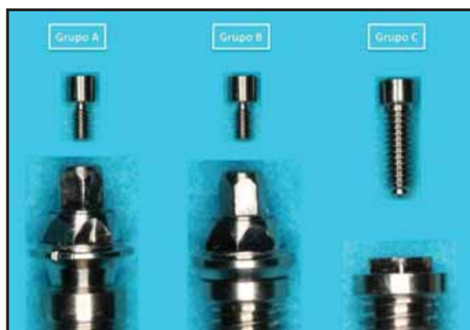
Figura C10 – Implantes com e sem intermediário e respectivos parafusos de retenção utilizados para a análise da desadaptação vertical na interface coroa/intermediário (Grupo A: CIE; Grupo B: CEE) e coroa/implante (Grupo C: CEU).
