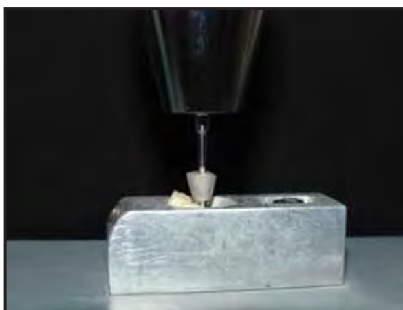
Figura C20 – Vista aproximada da chave hexagonal posicionada sobre o corpo-de-prova devidamente estabilizado pelo dispositivo metálico.
