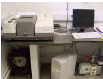
Figura 4.4.1: Espectrofotômetro NEXUS 670, Nicolet Instrument Corporation.
