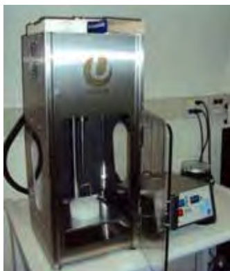
Figura 4.4.2: Ponta ultrassônica para dispersão das amostras.
