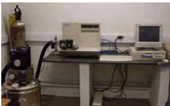
Figura 4.4.5: Equipamento de medidas térmicas MDSC da TA Instruments, modelo MDS2920.
