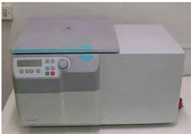
Figura 4.2.3: Centrífuga de origem Alemã Hermle Labortechnik Siemensstr. 25 78564 Wehingen utilizada para lavar as amostras de PPy obtidas pelo processo químico em microemulsão.
