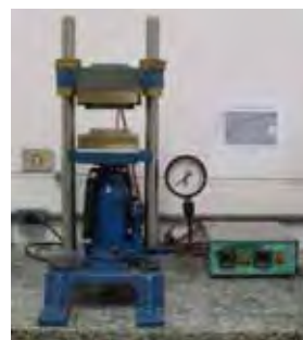
Figura 4.4.10: Prensa hidráulica MA 098 da MARCONI utilizada para fazer as pastilhas de PPy para medidas de condutividade elétrica. Dissertação de Mestrado
