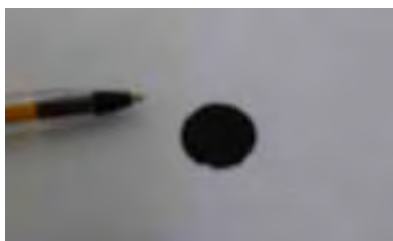
Figura 4.4.9: Pastilha de PPy feita na prensa para medidas de condutividade elétrica.
