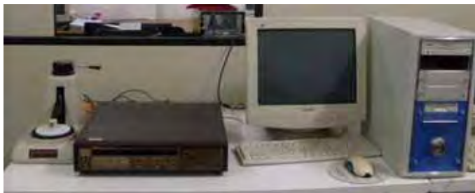
Figura 4.4.8: Fonte de tensão e corrente programável da Keithley modelo 236 acoplado a um computador para aquisição de dados.
