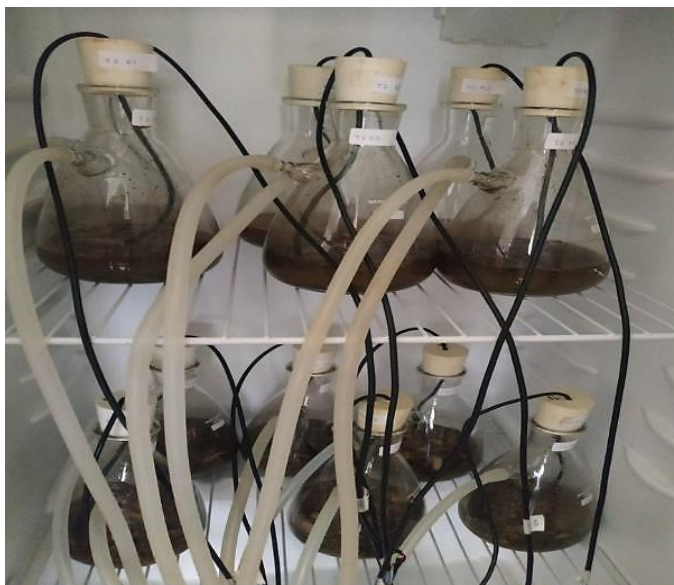
Figura 27- Frasco utilizado como biodigestor
