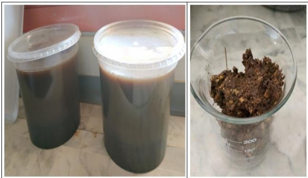
Figura 22- Inóculo de biodigestor em funcionamento e dejetos bovinos
