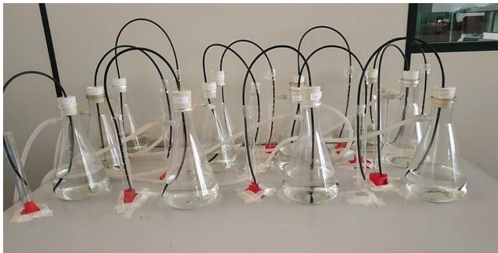
Figura 23- Sistema para medições do volume de Biogás produzido
