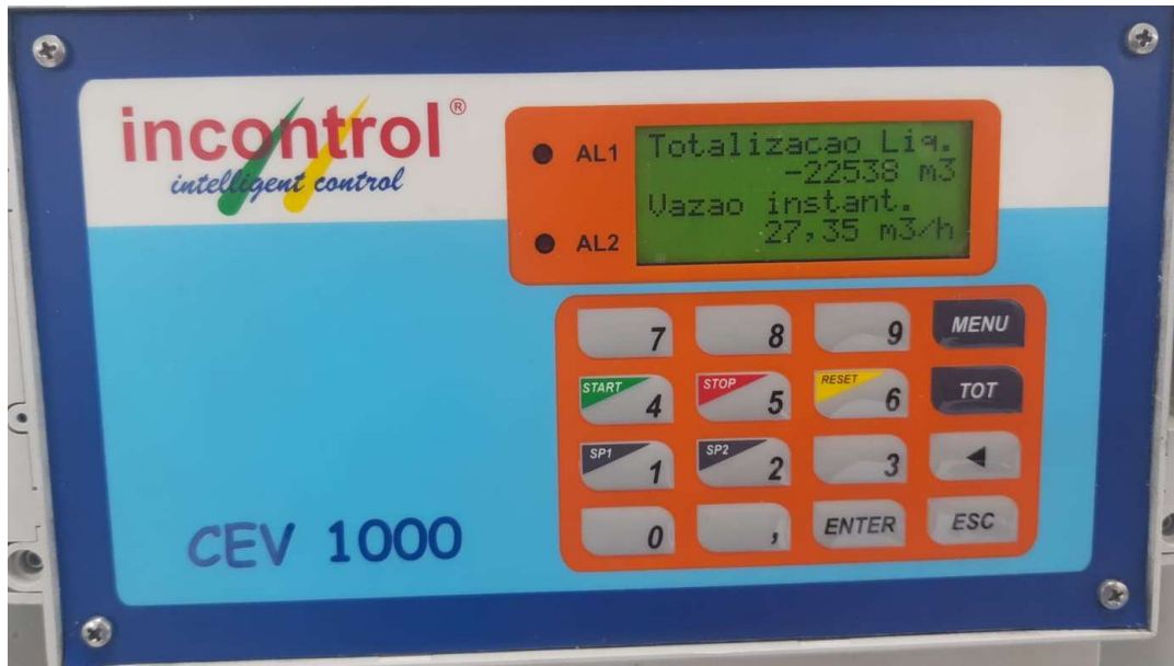
Figura 18 - Painel do medidor de vazão utilizado no ensaio.
