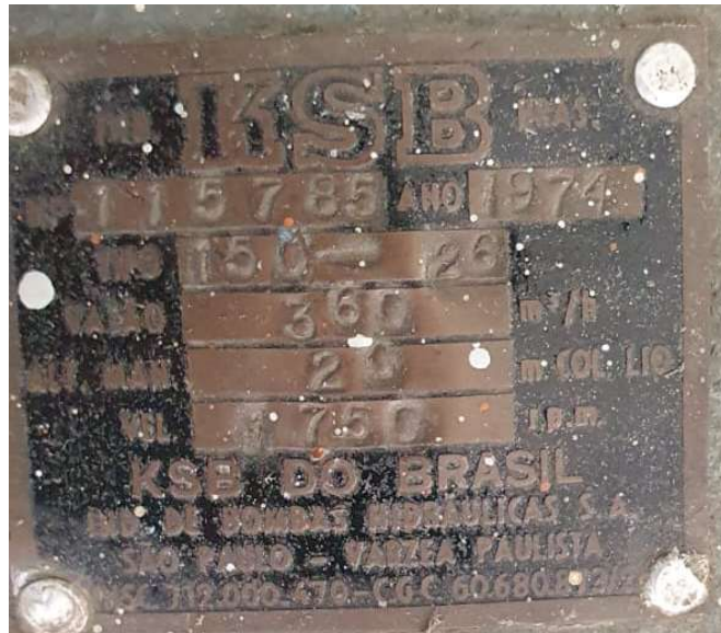
Figura 14 - Características da bomba utilizada no ensaio.
