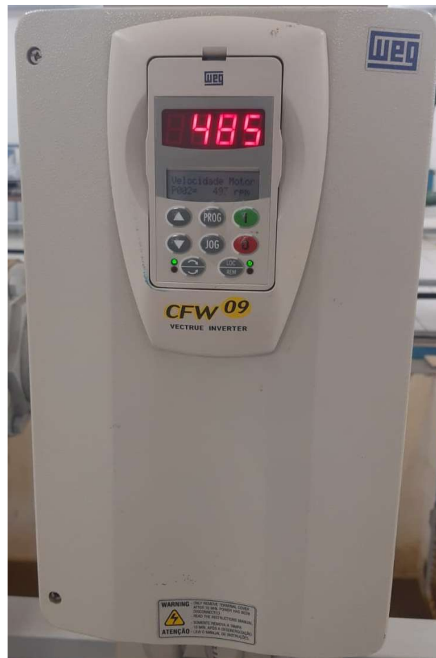
Figura 19 - Painel do Inversor de Frequências utilizado no ensaio.
