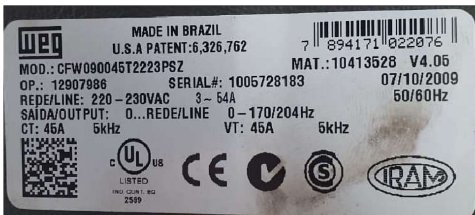
Figura 17 - Características do Inversor de Frequências utilizado no ensaio.
