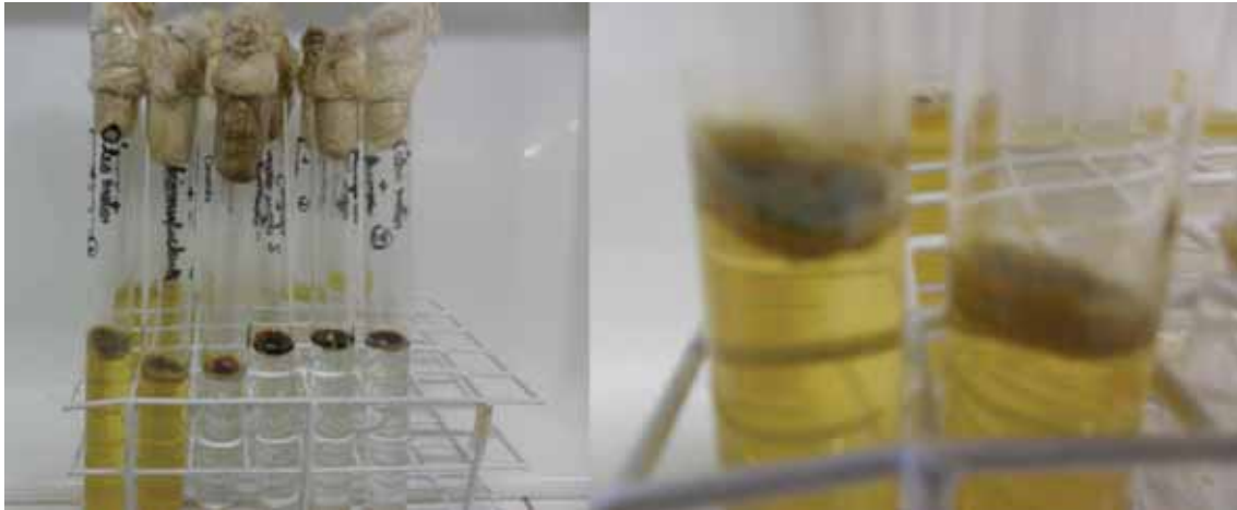
Figura 32. Testes de biorremediação de água contaminada com óleo de motor, com 21 dias de repouso. Na imagem à esquerda podem ser visualizados os diferentes tratamentos, sendo que os dois primeiros tubos representam a aplicação de biossurfactante; os tubos do meio, os experimentos controle; e os dois últimos tubo, a aplicação da suspensão de esporos de P. expansum . Em destaque, na imagem à direita, pode ser observada a colonização da camada superficial de óleo pelo microrganismo.
