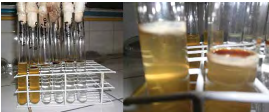
Figura 31. Testes de biorremediação de água contaminada com óleo de motor, com um dia de repouso. Na imagem à esquerda podem ser visualizados os diferentes tratamentos, sendo que os dois primeiros tubos representam a aplicação de biossurfactante; os tubos do meio, os experimentos controle; e os dois últimos tubo, a aplicação da suspensão de esporos de P. expansum . Em destaque, na imagem à direita, pode ser observada a formação de emulsão do óleo de motor, quando utilizado o biossurfactante.
