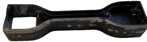
Figura 15 - Forma metálica para corte de corpos de prova.
