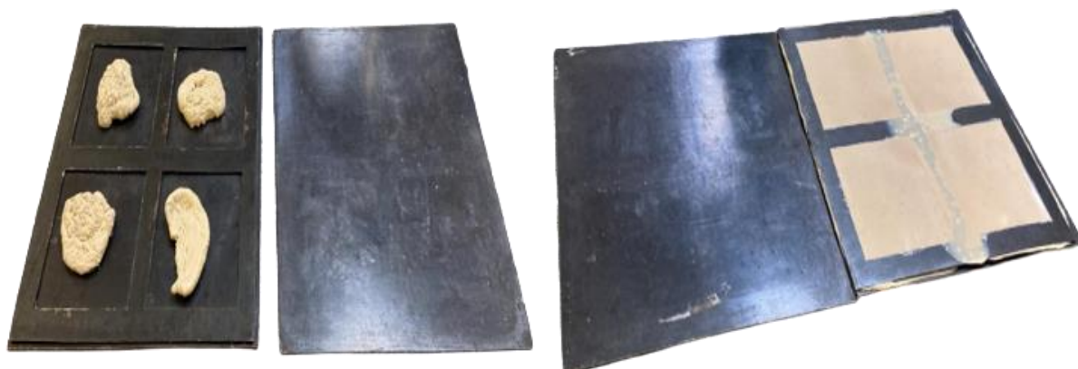
Figura 10 - Processo de moldagem dos corpos de prova.
