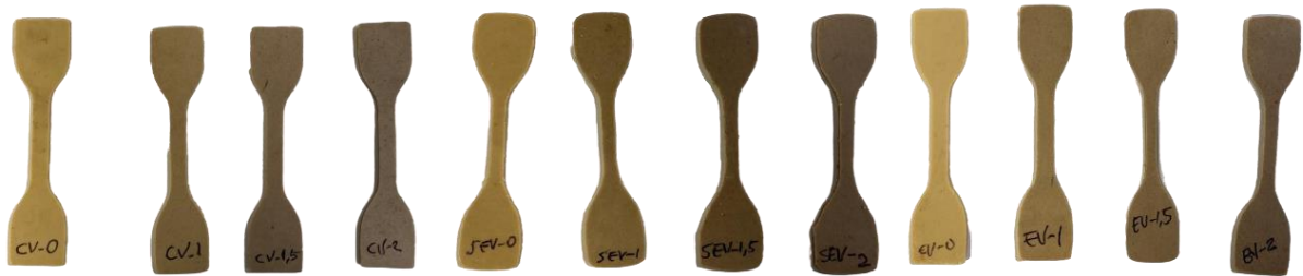
Figura 16 - Corpos de prova do ensaio de tração.
