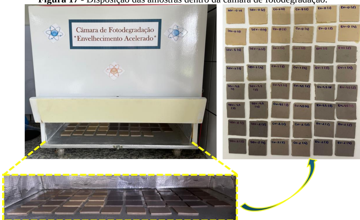
Figura 17 - Disposição das amostras dentro da câmara de fotodegradação.
