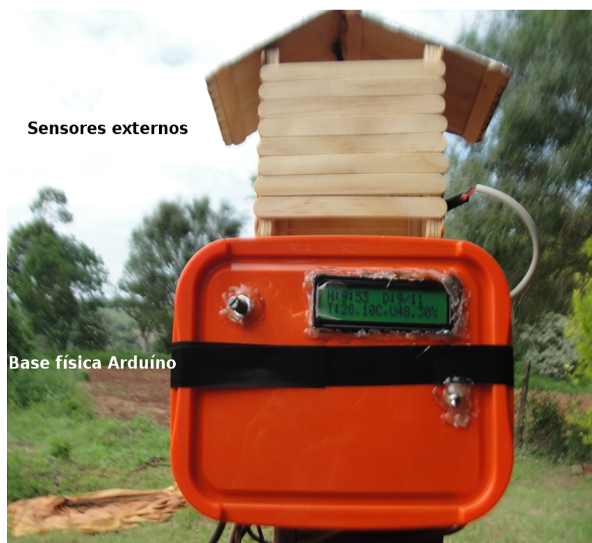
Figura 2. Base física do Arduino e sensores instalados para medição das variáveis de temperatura e umidade em Botucatu/SP
