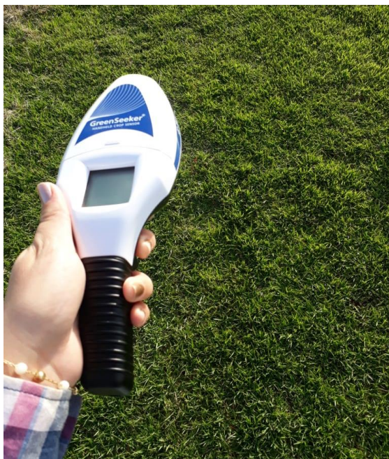
Figura 8 – Foto do aparelho GreenSeeker Handheld Crop Sensor (Trimble®) utilizado na avaliação de NDVI.
