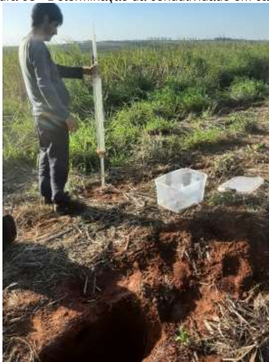
Figura 08 - Determinação da condutividade em campo
