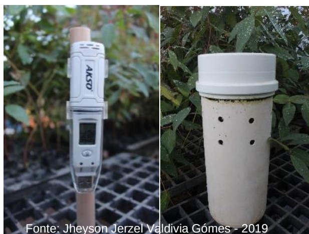
Figura 11 – Datalogger à prova d'água marca AKSO, modelo AK 174 instalado no interior dos canteiros.
