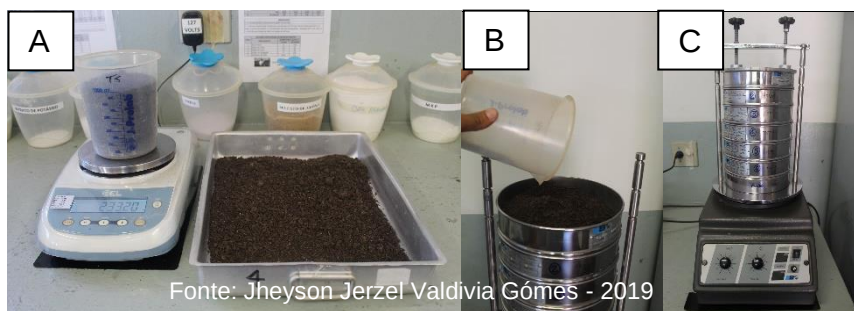
Figura 5 – Pesagem do substrato (A); disposição do substrato no jogo de peneiras (B); agitador eletromagnético (C).
