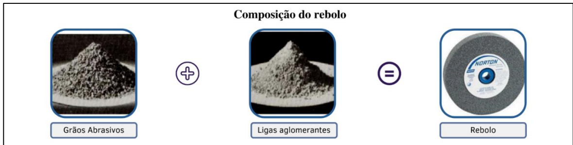
Figura 3 Elementos de composição do rebolo, adaptado de (LOPES, 2018)
