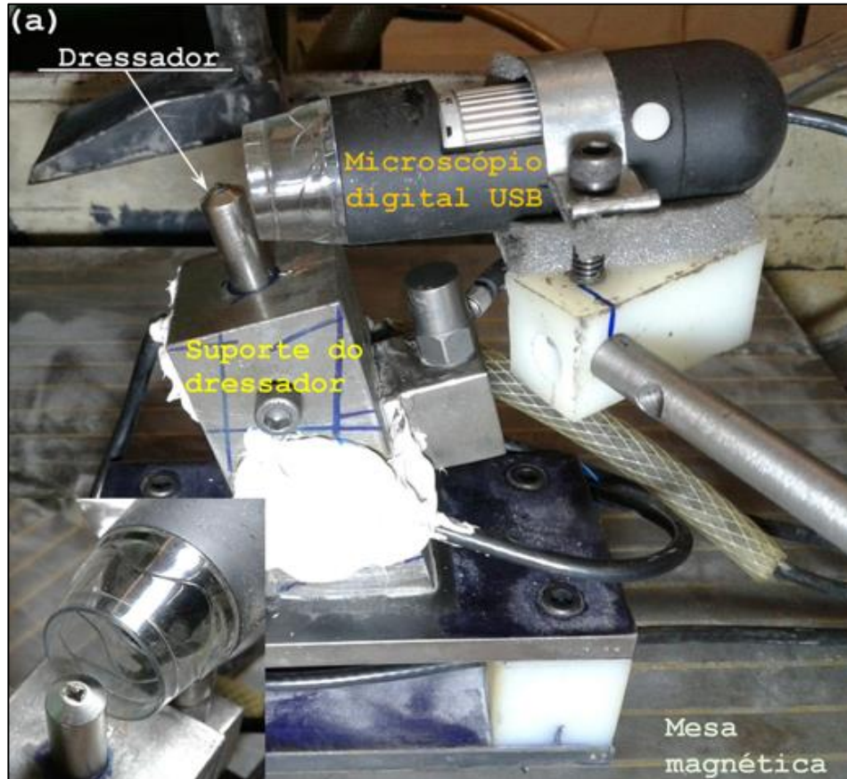
Figura 15 Banco de ensaios para aferição da largura de atuação do dressador (LOPES et al. , 2017)
