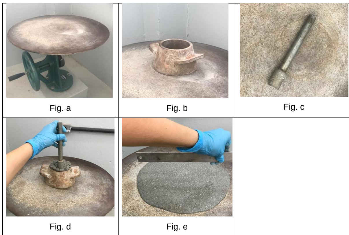
Quadro 4: Procedimentos do ensaio de índice de consistência.
