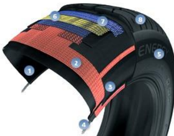
Figura 1: Estrutura do pneu.
