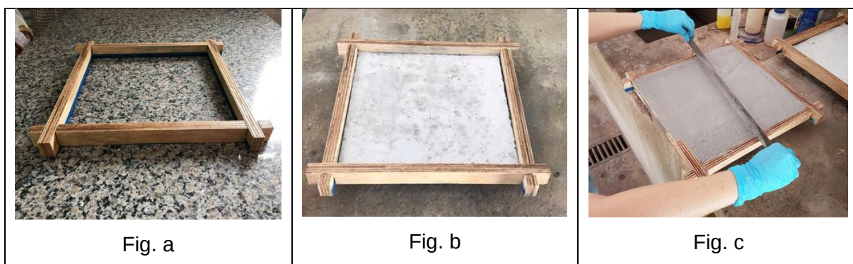
Quadro 11: Procedimentos para confecção dos corpos de prova.
