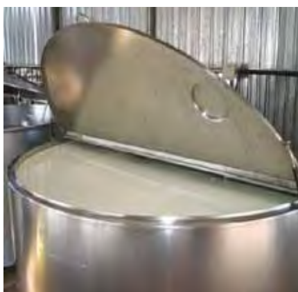
Figura 3 - Tanque de refrigeração
