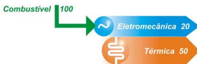
Figura 1. Cogeração com produção de energia térmica e eletromecânica em simultâneo.
