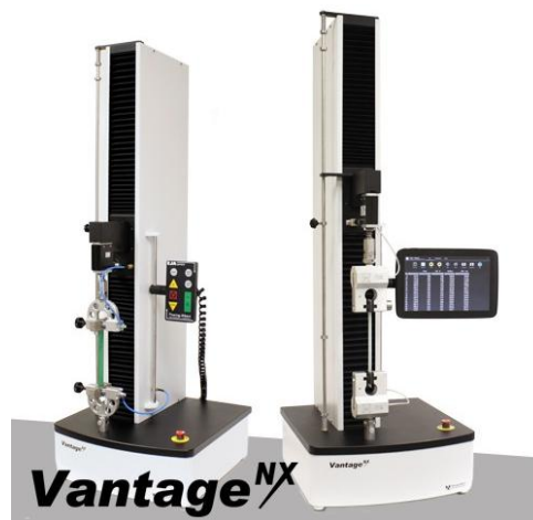
Figura 4.3. Equipamento empregado nos testes de tração do selo ( tensile test ) (*)
