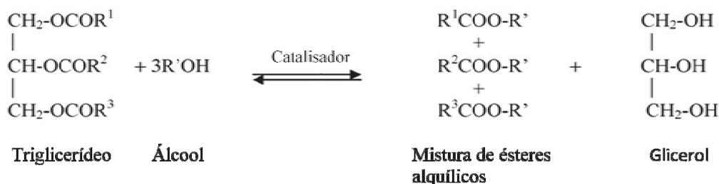
Figura 1 – Reação de transesterificação de triglicerídeo.
