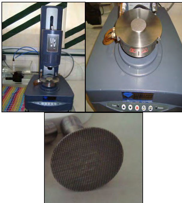
Figura 4.1: Reômetro AR-2000EX (TA Instruments, Delaware, USA) geometria de placas paralelas serrilhadas.
