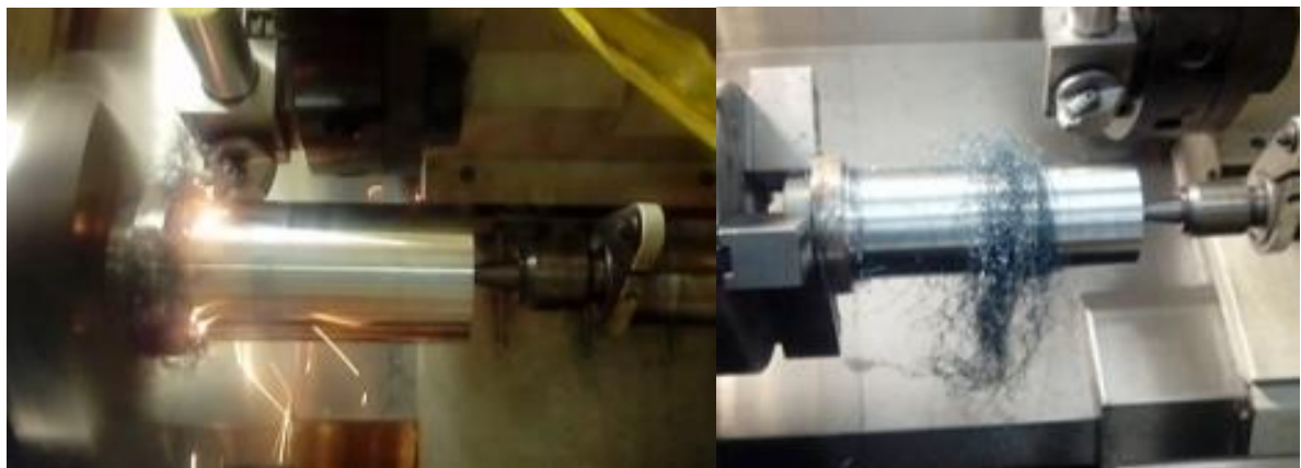
Figura 53 – Cavacos gerados para f=0,15\text{mm/rot} e a_p=0,25\text{mm}
