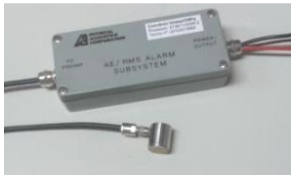
Figura 20 - um sistema de captação de emissão acústica da marca PHYSICAL ACOUSTICS CORPORATION
