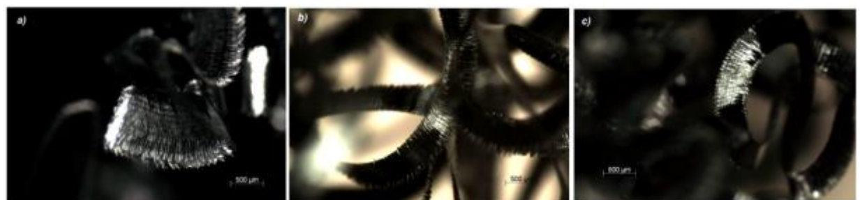
Figura 52 - Cavacos para V_c=160\text{m/min} e a_p=0,25\text{mm} . a) f=0,05 ; b) f=0,10 ; c) f=0,15 .
