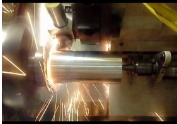
Figura 56– Processo de torneamento para V_c=500\text{m/min} .
