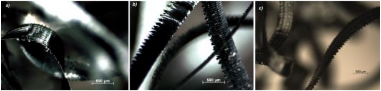
Figura 49 - Cavacos para V_c=200\text{m/min} e a_p=0,15\text{mm} . a) f=0,05 ; b) f=0,10 ; c) f=0,15 .
