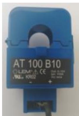
Figura 18 – Sensor de potência marca LEM modelo AT 100 B10.
