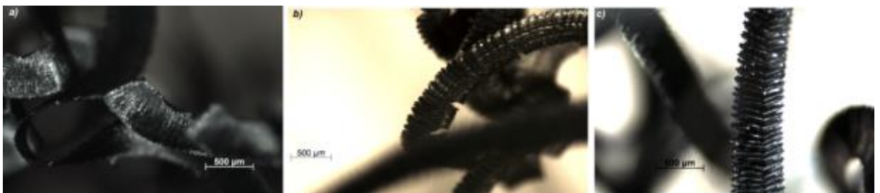
Figura 51 - Cavacos para V_c=160\text{m/min} e a_p=0,15\text{mm} . a) f=0,05 ; b) f=0,10 ; c) f=0,15 .
