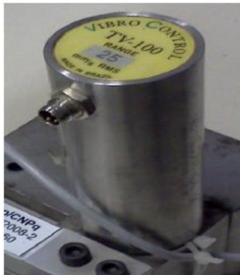
Figura 19 – Módulo de vibração modelo TV100
