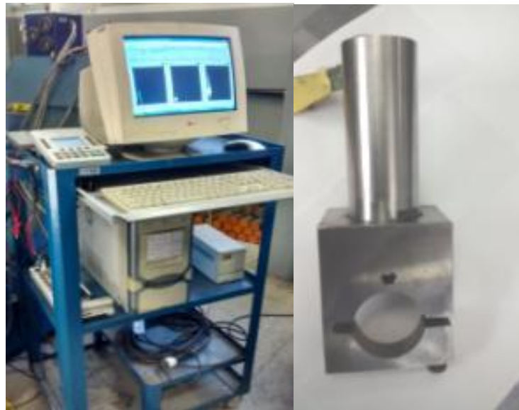
Figura 16 – Sistema de aquisição de dados e dispositivo de fixação dos sensores
