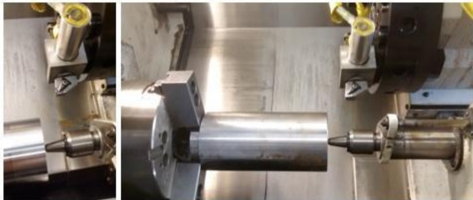
Figura 14 - Suporte para ferramentas tipo CAPTO marca Seco e corpo de prova para torneamento
