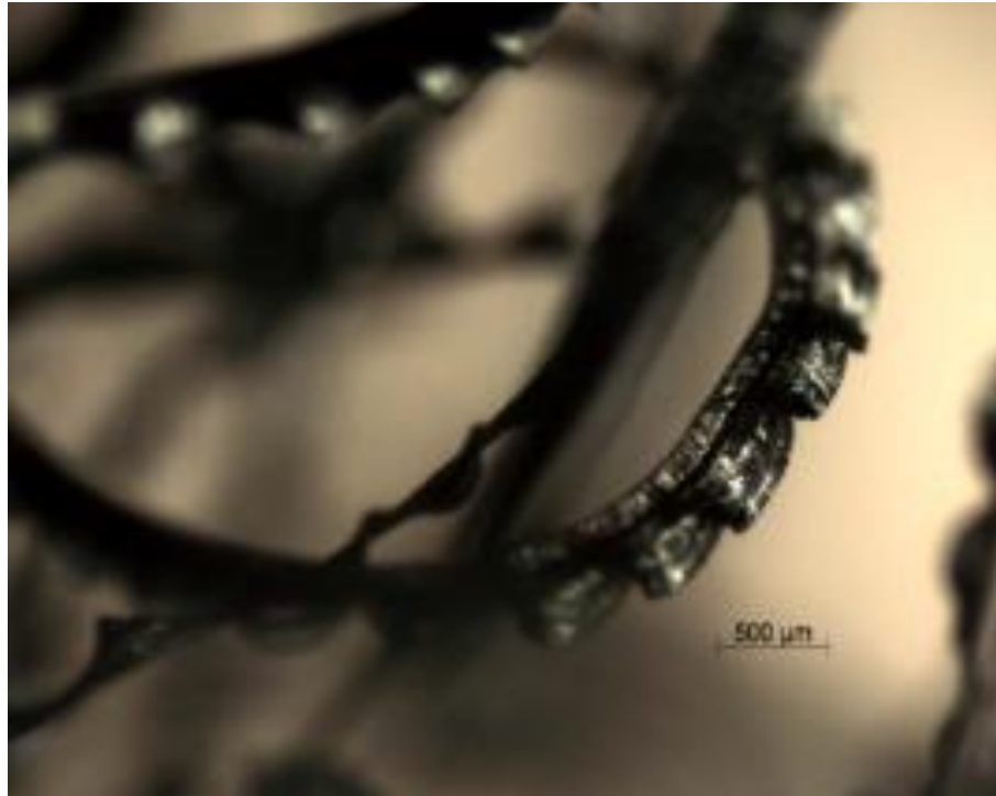
Figura 48 – Cavaco do tipo dente de serra ( V_c=200\text{m/min} , a_p=0,5\text{ mm} e f=0,2\text{ mm/rot} )
