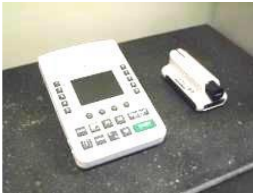
Figura 21- Rugosímetro marca Mahr modelo Marsurf
