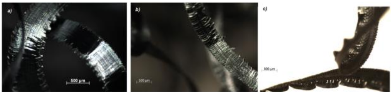
Figura 50 - Cavacos para V_c=200\text{m/min} e a_p=0,25\text{mm} . a) f=0,05 ; b) f=0,10 ; c) f=0,15 .
