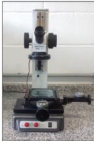
Figura 22 - Estereoscópio da Marca Mahr, modelo MarVision MM200.
