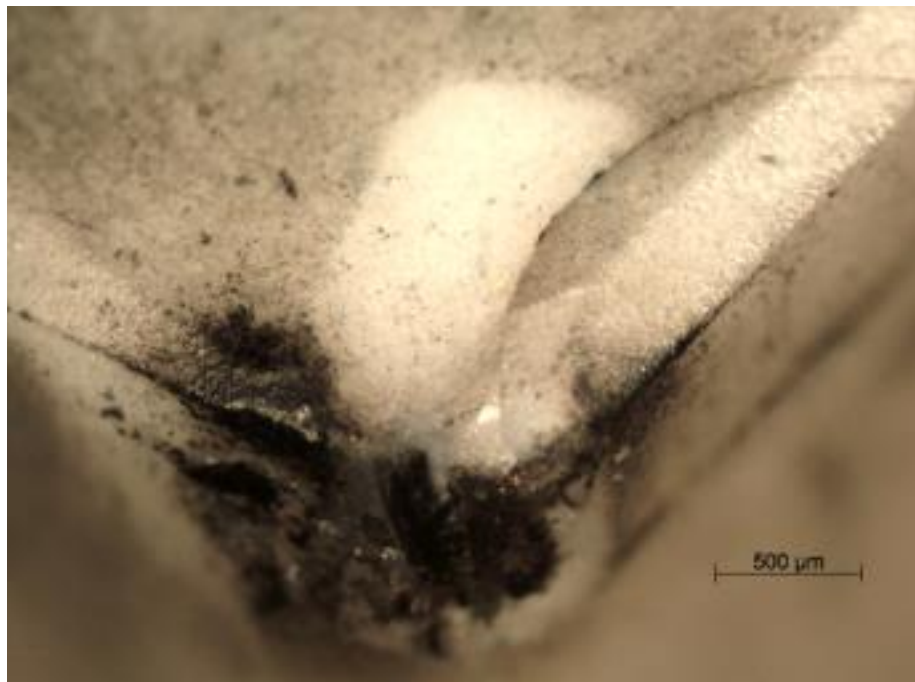
Figura 41 – Desgastes e avarias para V_c=200\text{m/min} f=0,15\text{mm/rot} a_p=0,25\text{mm}
