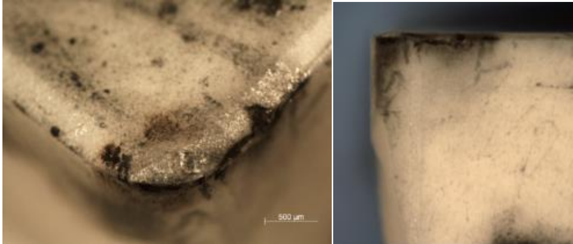
Figura 47 – Desgastes pra V_c=160\text{m/min} e a_p=0,15
