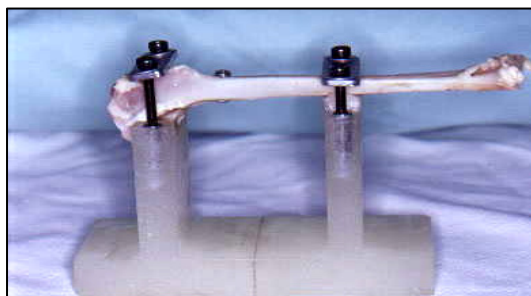
Figura 4.23 - Tibia esquerda do coelho nº 2, imobilizada no suporte de acrílico pelas presilhas, com o implante já fixado
