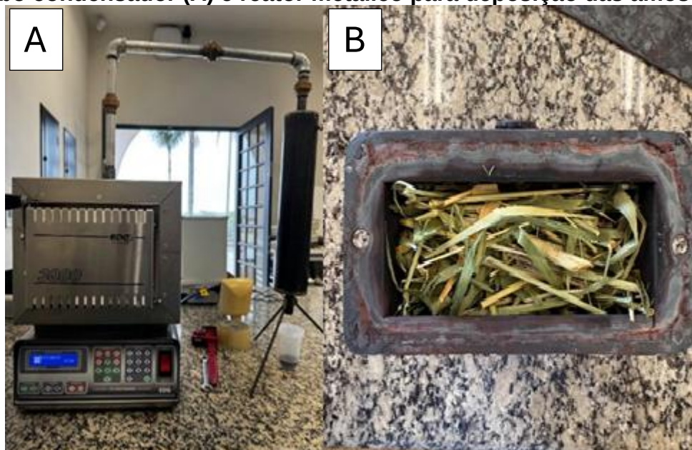
Figura 1 - Forno elétrico para anéis – modelo EDG, 3000 5P, adaptado com um tubo condensador (A) e reator metálico para deposição das amostras (B)
