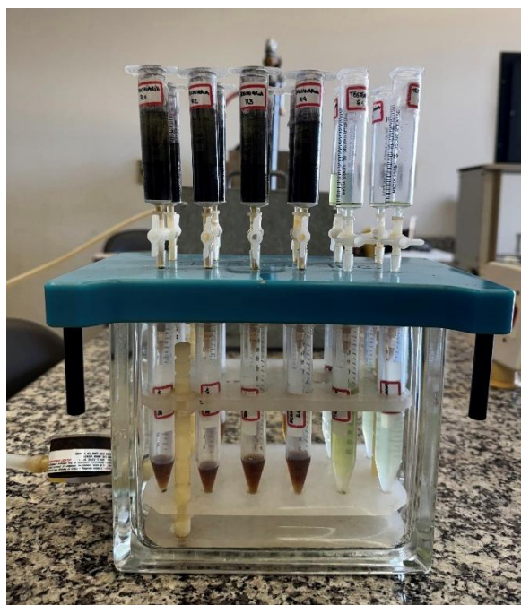
Figura 5 - Técnica de Manifold
