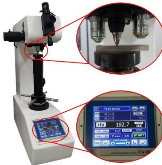
Figura 23 – Durômetro utilizado para a realização dos ensaios de dureza com detalhes do indentador, posição da amostra e tela.
