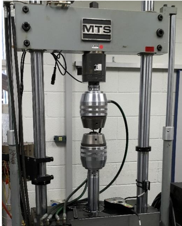
Figura 25 – Equipamento servo-hidráulico utilizado para a realização dos ensaios de tração.
