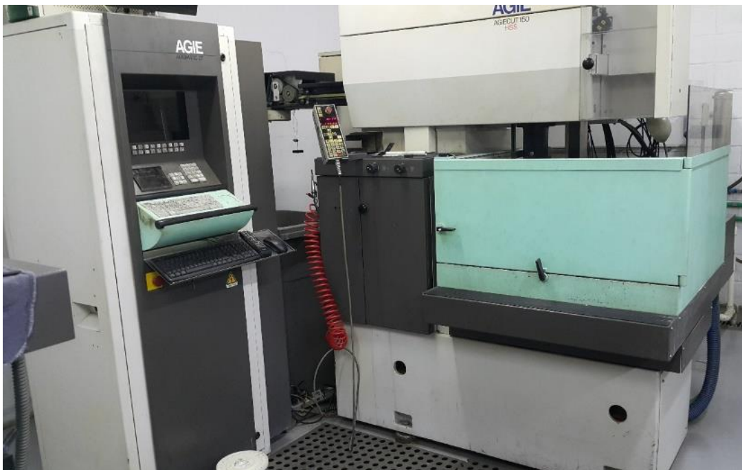
Figura 19 – Máquina de eletroerosão a fio utilizada para a retirada das amostras da placa de impressão.
