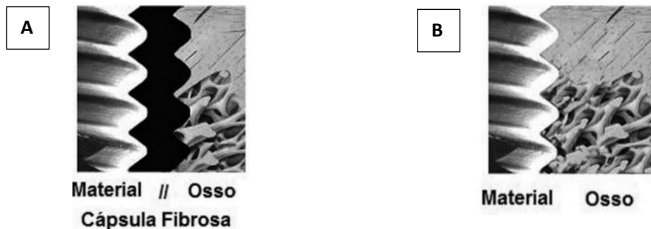
Figura 2 – Comportamento biológico dos biomateriais. (A) biotoleráveis e bioinertes e (B) bioativos.
