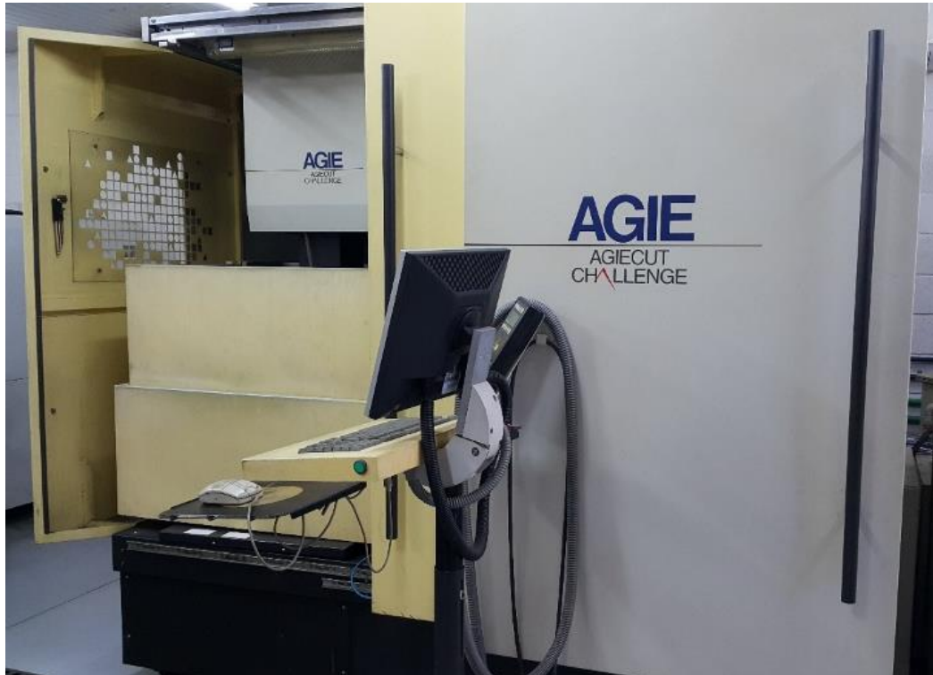
Figura 20 – Máquina de eletroerosão a fio utilizada para a confecção dos entalhes nas amostras de tenacidade à fratura.
