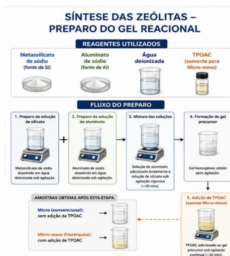
Figura 4: Fluxograma do preparo do gel reacional utilizado na síntese das zeólitas
