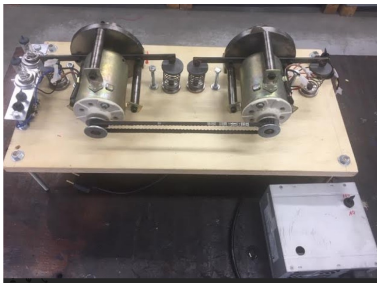
Figura 56 – Conjunto mecânico final
