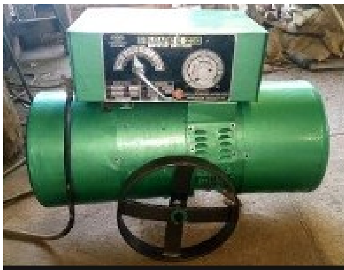
Figura 23 – gerador de corrente contínua com motor de indução
