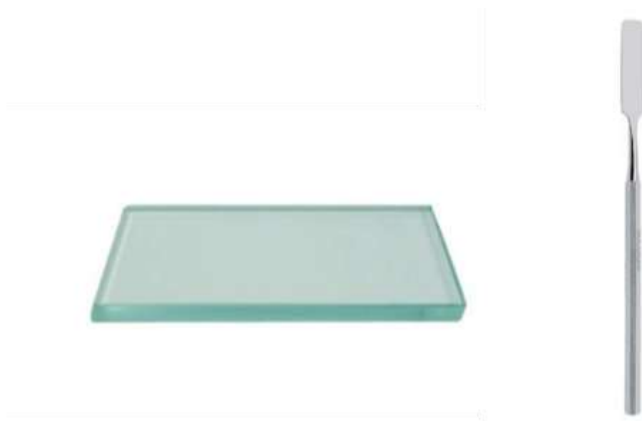
Figura 7: Placa de vidro e espátula no. 36 utilizadas para manipulação do silicone, nanopartículas e tinta a óleo.
