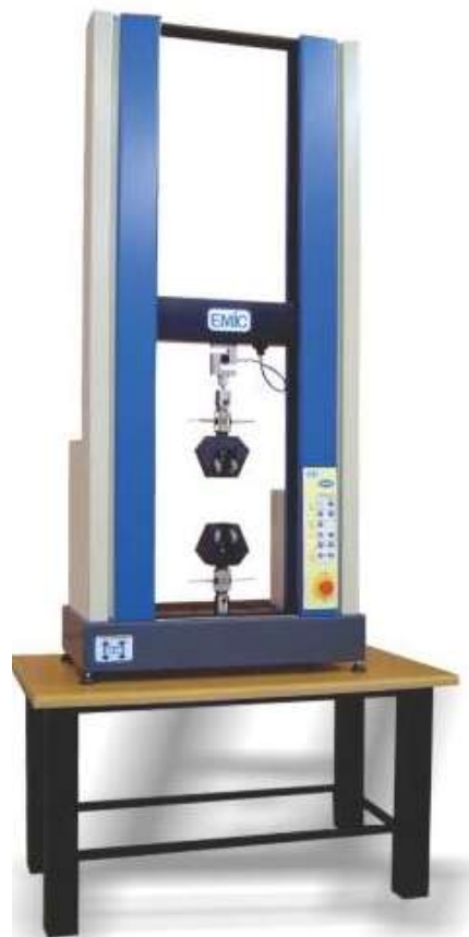
Figura 10: Máquina de Ensaio Universal (EMIC, EMIC DL 3000, São José dos Pinhais, PR, Brasil), utilizada na realização do teste de resistência à ruptura
