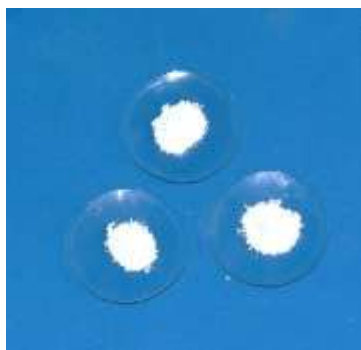
Figura 3: Nanopartículas de ZnO, BaSO 4 e TiO 2 (Apothicário, Araçatuba, São Paulo, Brasil) utilizadas como opacificadores.
