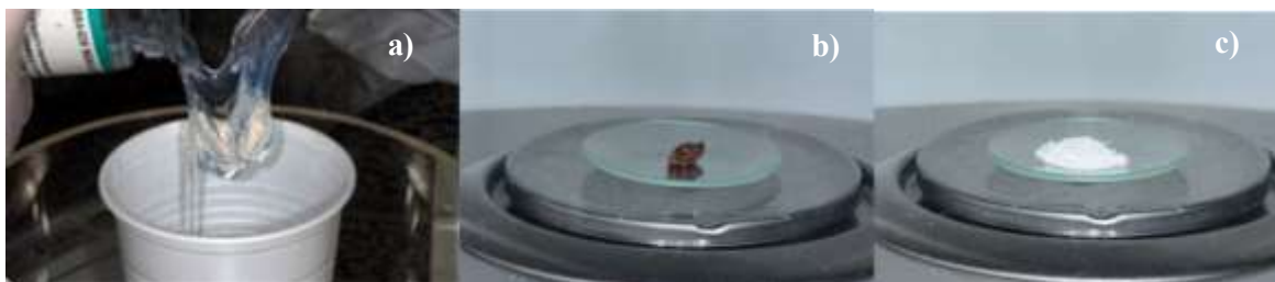
Figura 12: Pesagem dos materiais em balança analítica digital: a) Silicone, b) Tinta a óleo e c) Nanopartícula.
