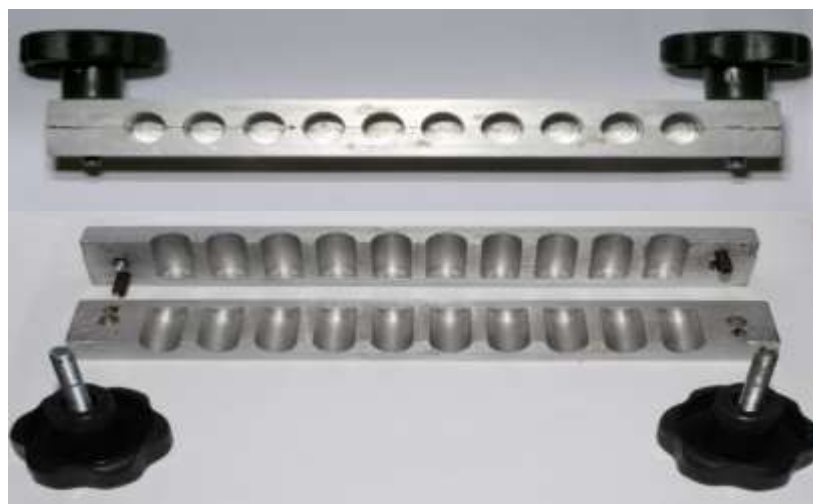
Figura 6: Matriz metálica utilizada na confecção das amostras a serem submetidas ao teste de deformação permanente.
