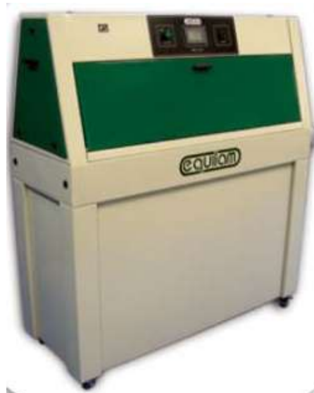
Figura 11: Câmara de envelhecimento acelerado para não-metálicos (EquilamDiadema, SP, Brasil), utilizada para o ensaio de envelhecimento das amostras.
