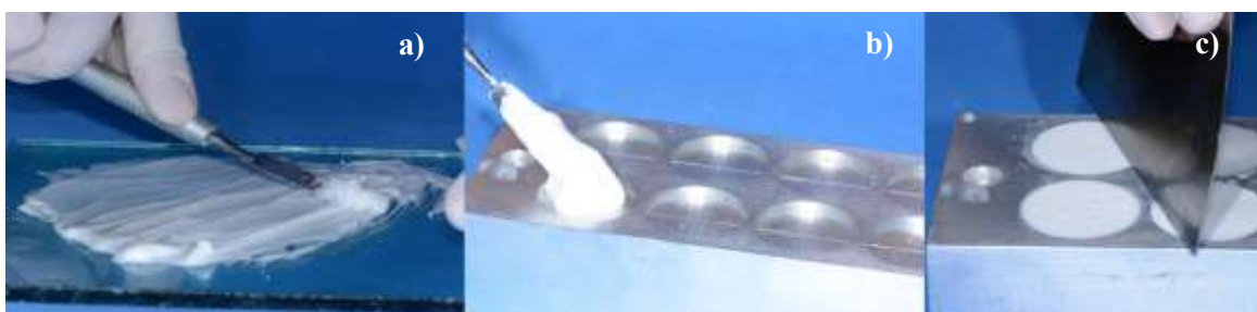
Figura 13: Manipulação e pigmentação do silicone: a) incorporação de nanopartículas ao silicone sobre placa de vidro, b) Silicone sendo inserido no interior da matriz metálica e c) regularização da superfície das amostras com auxílio de espátula metálica.
