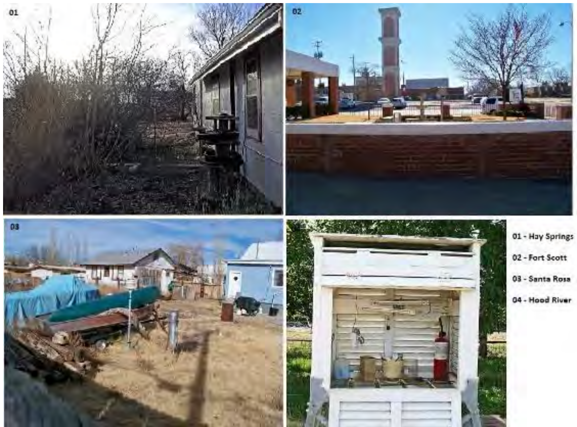
Figura 12: Representação da má localização das estações meteorológicas do tipo MMT (Minimum Maximum Temperature Sensor) da base de dados NOAA. Fonte: Anthony Watts (2007) In. www.surfacestations.org
