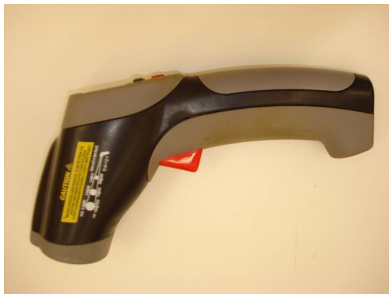
Figura 1 - Termômetro digital ICEL TD-971 (Icel Instrs e componentes eletrônicos Ltda/Curitiba,PR) com capacidade de análise de -50 a 750 graus Celsius e sistema de leitura por irradiação de luz infravermelha.
