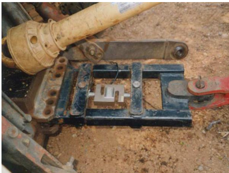
Figura 5. Célula de carga montada na barra de tração do trator. (GARCIA et al., 2003).
