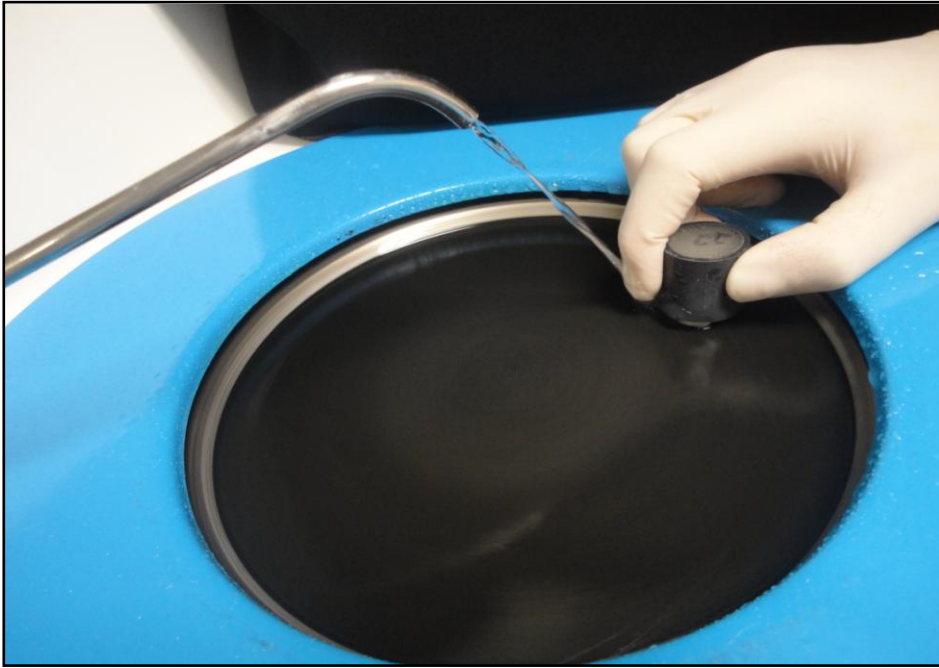
Figura 3 – A face vestibular sendo desgastada e polida com discos abrasivos, montados em Politriz Aropol E (Arotec Indústria e Comércio Ltda).
