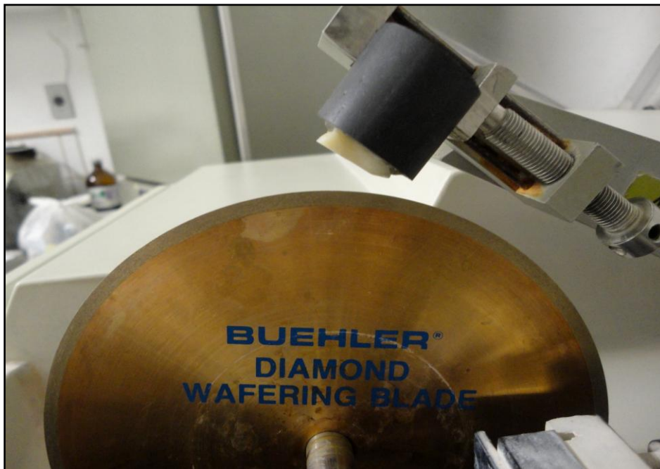
Figura 15 – Corpo de prova posicionado em cortadeira metalográfica Isomet 2000 (Buehler), para realização do seccionamento no sentido cervico-incisal.
