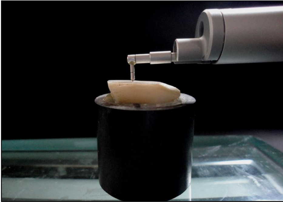
Figura 10 – Leitura realizada pelo rugosímetro, após a microabrasão.
