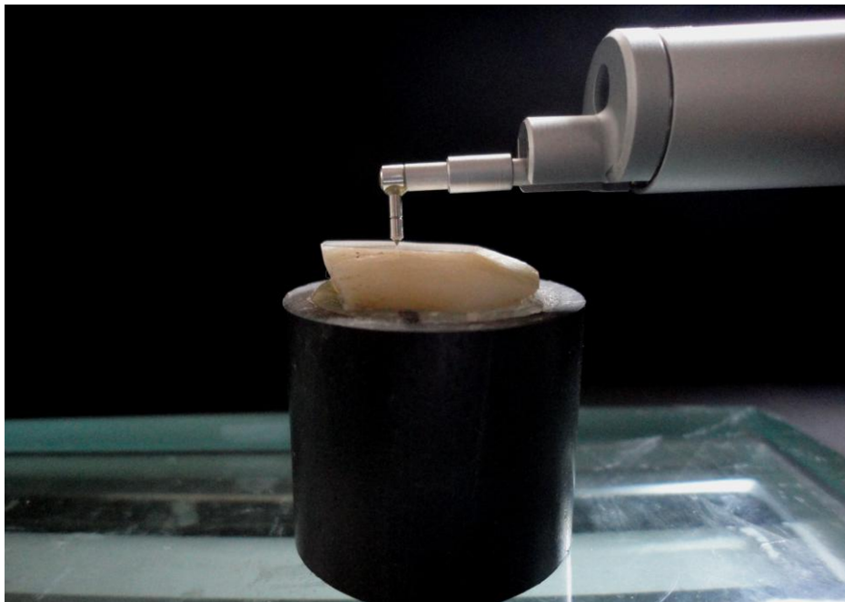
Figura 6 – Realização da leitura no rugosímetro SJ-401 (Mitutoyo, Kanagawa, Japão).
