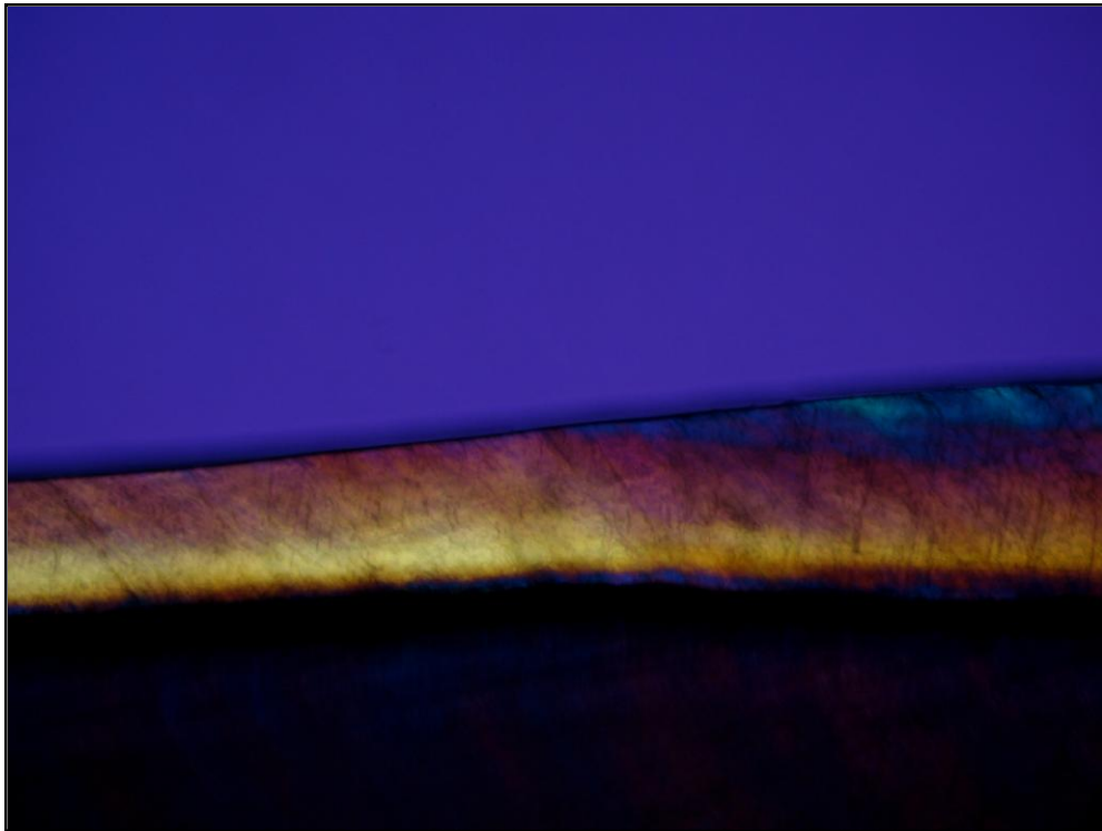
Figura 26- Em maior aumento, verifica-se ausência de degrau entre a área abrasionada e a íntegra (200x).
